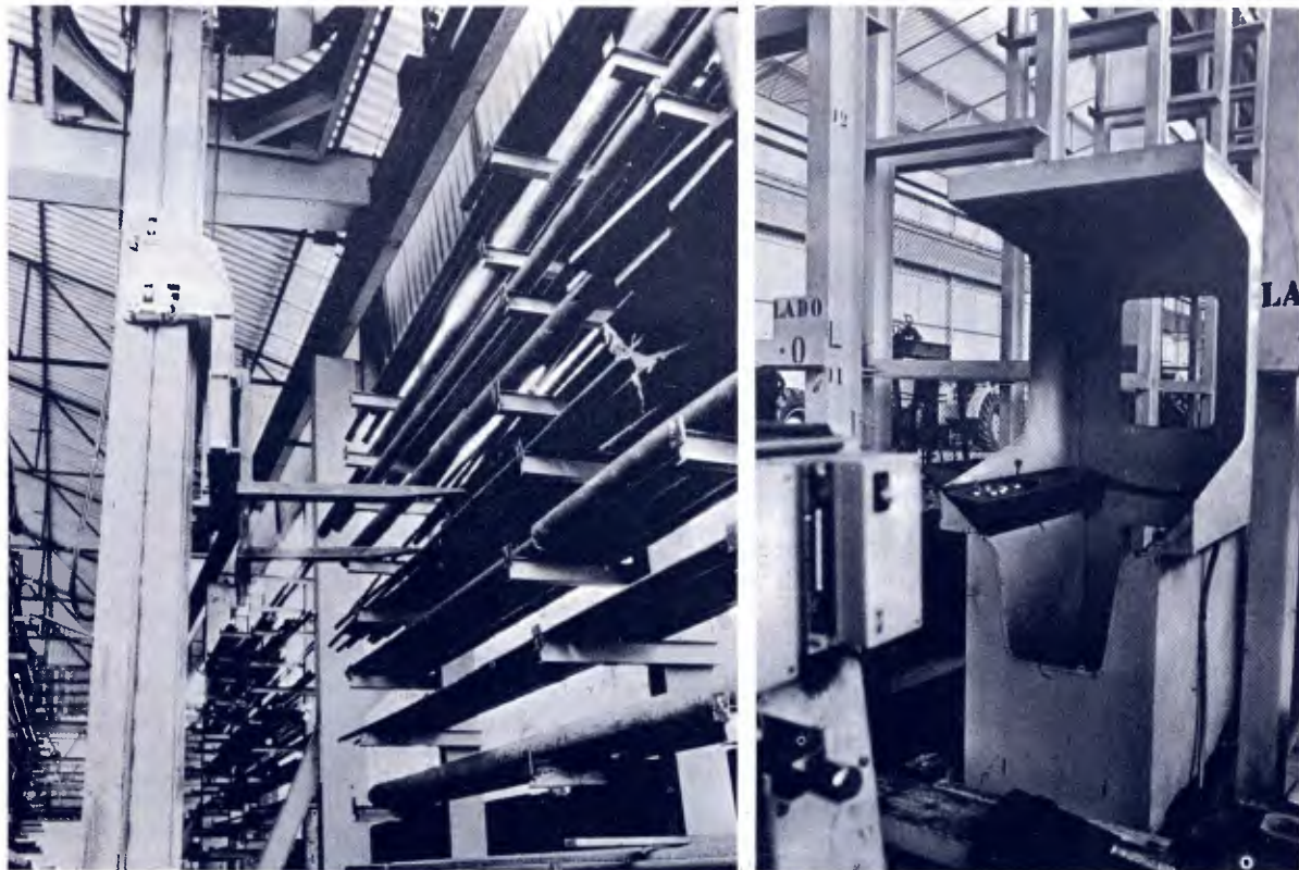
Do carrinho giratório desce o mastro, no qual correm os garfos. À direita: cabina de comando do Palstack.
