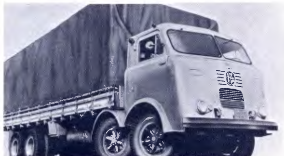
O mais novo lançamento da FNM é o primeiro veículo nacional com dois eixos direcionais. Carrega 27 t.
