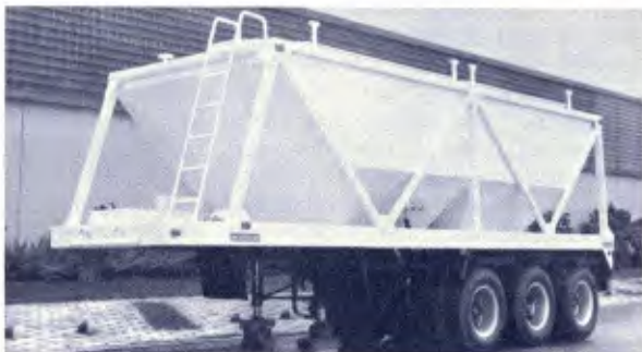
Massari: silos de tampas acionadas simultaneamente.
