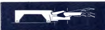
Carregador tipo GT - móvel e removível com 2 articulações - para vagões até maior porte.
