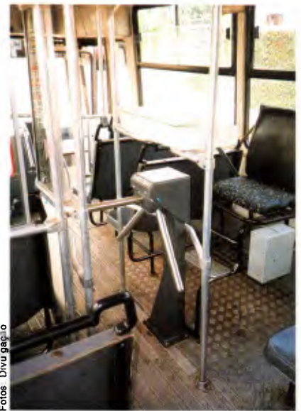
Com e sem eletrônica: Sistema WA IV, da Wolpac, permite operação mecânica, com SBAs e SBIs
