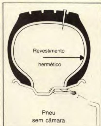
no Brasil. Como se sabe, a Goodyear estreou no mercado com o radial sem câmara G 291, cuja principal qualidade é a de não esvaziar rapidamente devido ao revestimento interno impermeável, que envolve o material pe-
