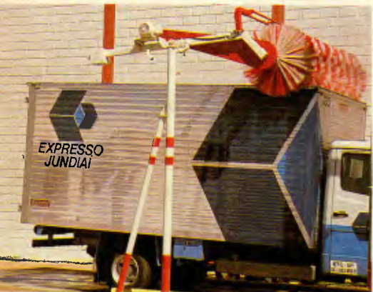
O LAVATETOS RUF 2641, é uma máquina que complementa o Rotomóvel. Uma escova pendular lava veículos de 2,60 a 4,10 m de altura.
