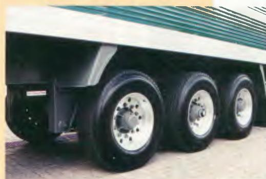
As rodas forjadas de alumínio da Alcoa podem ser financiadas ou compradas com 28 dias faturados. A roda de alumínio diminui o peso do veículo e aumenta a capacidade de carga. A maior vida útil dos pneus é resultante da perfeita centragem das rodas, devido à diminuição da temperatura no conjunto de freios, pois o alumínio dissipa o calor mais rapidamente.
