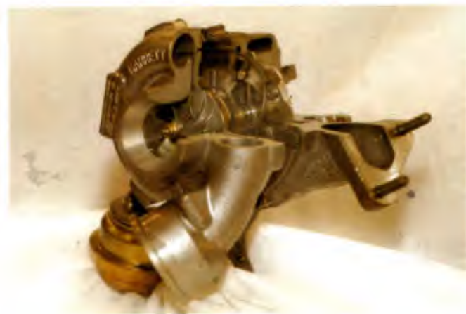
GT22 VNT, a turbina de geometria variável é uma evolução do sistema de sobrealimentação
