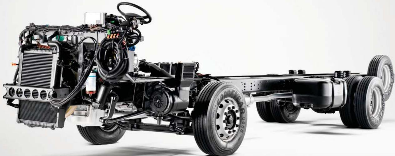
**O chassi 17.260 OD é o único com motor dianteiro de seis cilindros do mercado que não necessita de Arla 32, já que vem equipado com a tecnologia EGR (Recirculação de Gases de Exaustão)**
