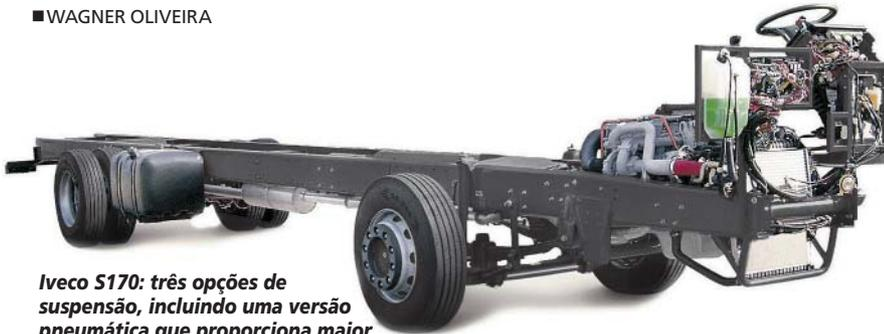
**Iveco S170: três opções de suspensão, incluindo uma versão pneumática que proporciona maior conforto aos passageiros.**
