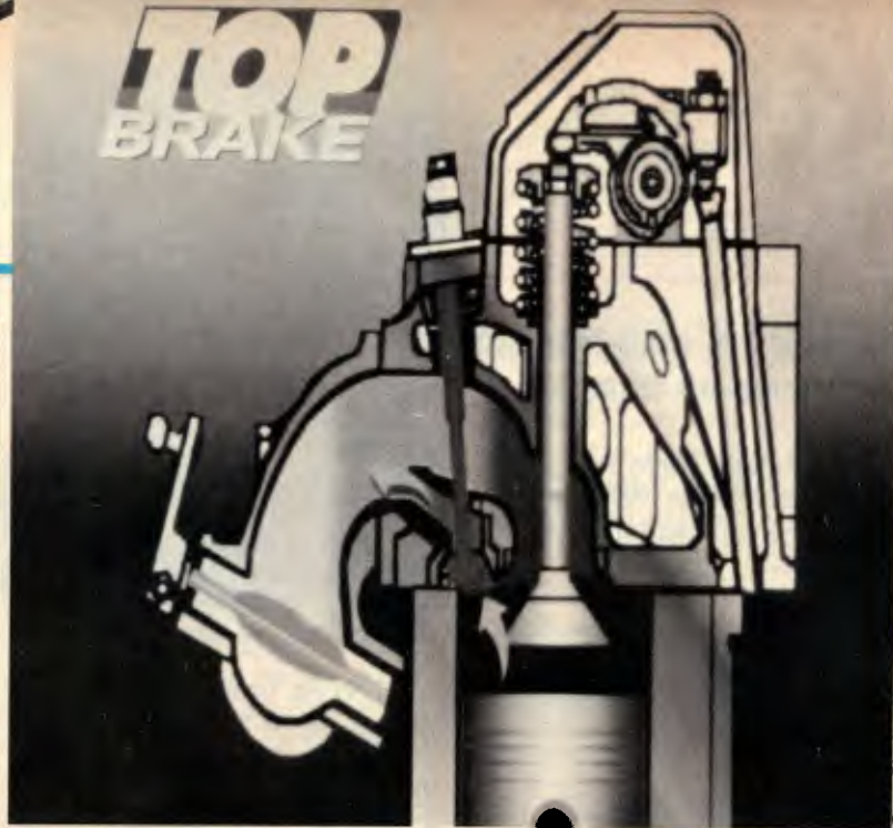
Os novos pesados já vêm equipados com o Top-Brake, que é acionado pelo painel
