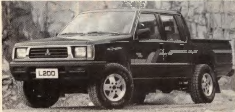
A picape L-200, da Mitsubishi, cabina dupla, na versão 4x2, dispõe de motor 2.5 turbo diesel, com 90 cv de potência
