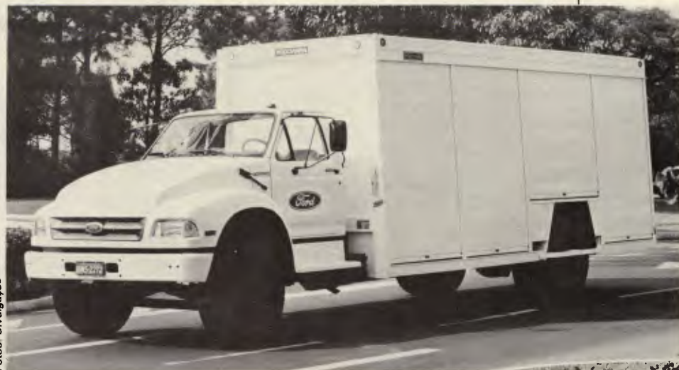
A Linha F pode ser equipada com carroçaria rebaixada para transporte de bebidas
