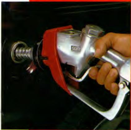
Bico da mangueira da bomba de combustível equipado com antena do sistema CTF.
