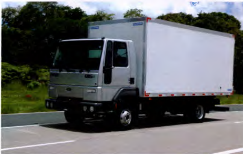
O modelo C-815e, com pbt de 8.250 kg, tem potência de 150 cv
