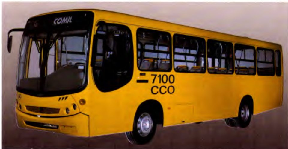
O urbano Svelto, em cinco versões, possui estrutura modular em aço zincado e maior área envidraçada no pára-brisa, nas janelas e nas portas
