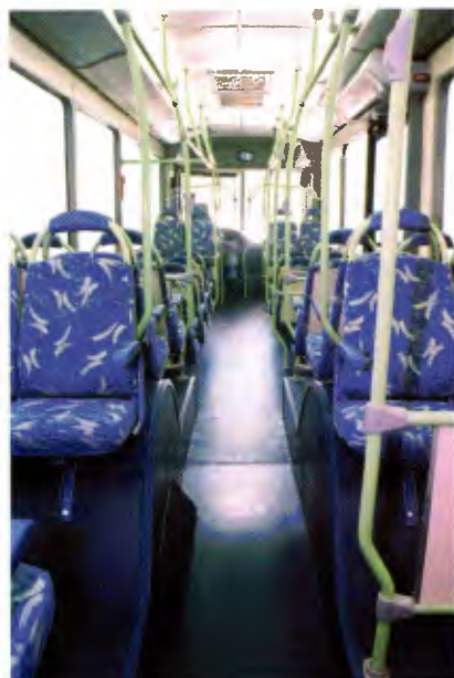
No trólebus Busscar low floor não há nenhum degrau no interior ou em suas portas
