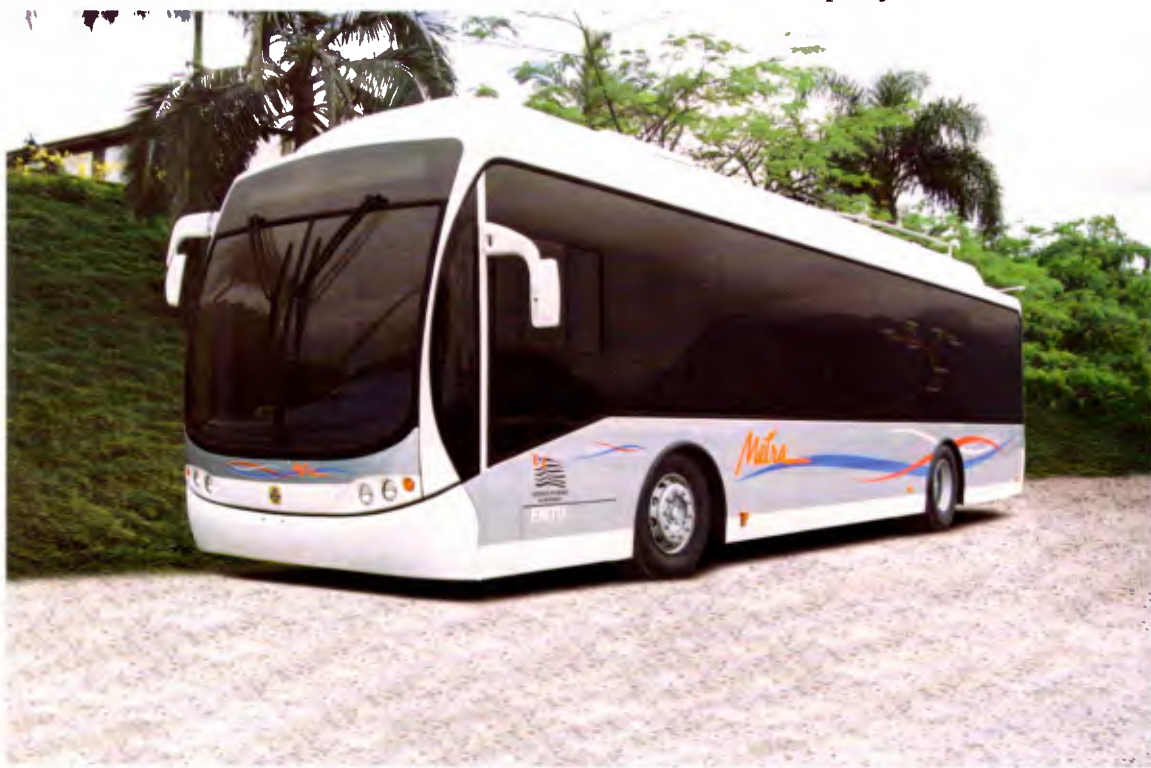
Trólebus low floor com chassi da HVR, encarroçado pela Busscar, tem piso totalmente baixo, ao nível da calçada, para facilitar a entrada e saída dos passageiros
