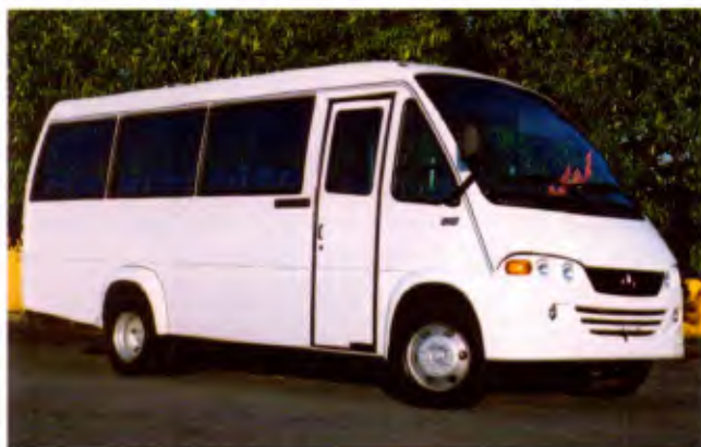
A carroceria Vicino, desenvolvida pela DaimlerChrysler e Marcopolo, equipa os chassis 412 D e LO 610
