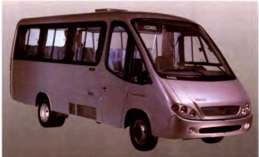
O modelo Bella, sobre mecânica Sprinter, é disponível nas versões executiva (15 lugares) e lotação (24 assentos)
