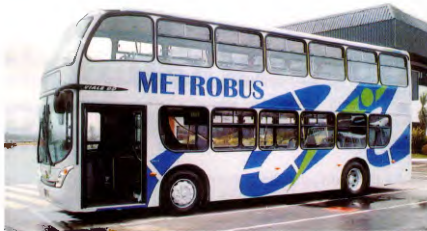
Viale Double Decker de piso baixo tem espaço interno maior e vista panorâmica: serve tanto para o transporte convencional como para city tours
