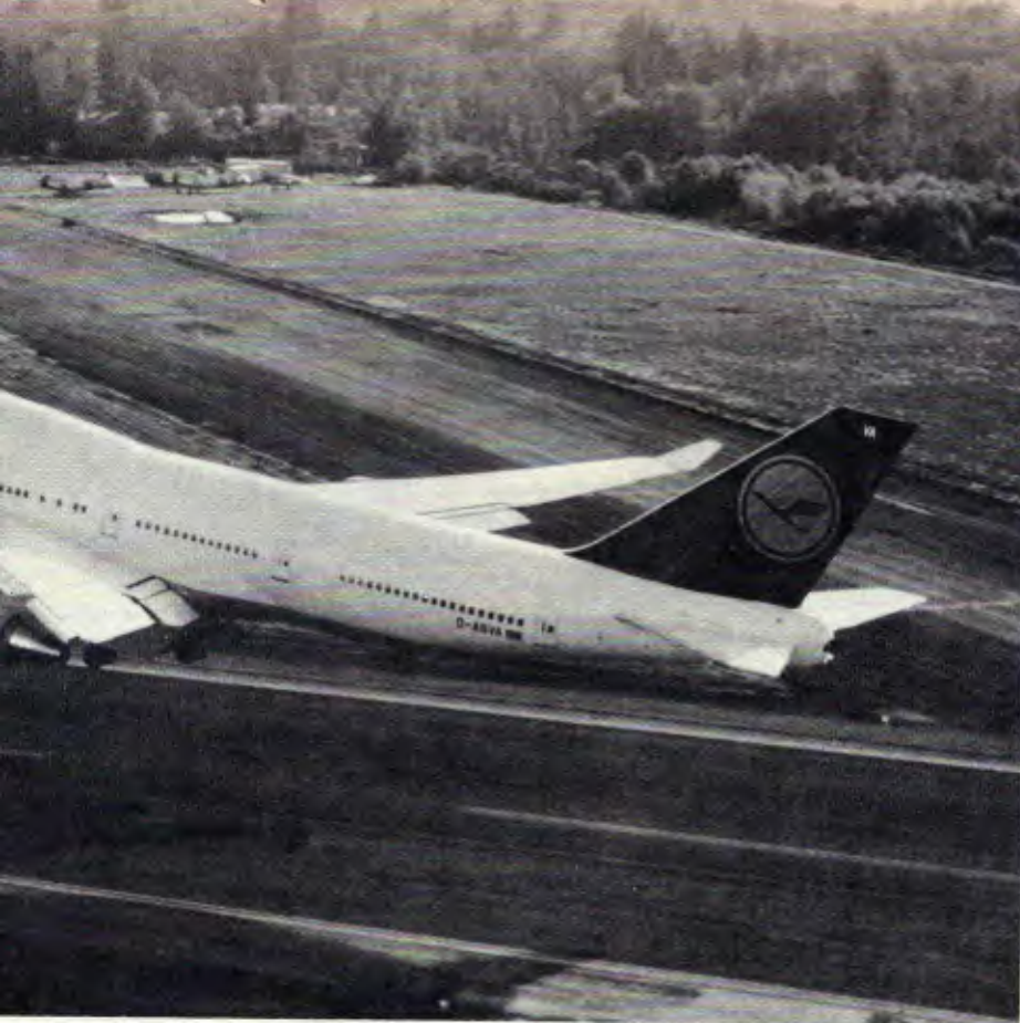
O 747-400 oferece até seiscentos lugares. O da Lufthansa tem 388. Na cabina, o número de instrumentos caiu de mil para quatrocentos.
