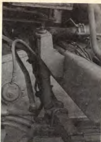
Para evitar carroçaria muito alta, o amortecedor foi rebaixado. O modelo da Ciferal ficou mais baixo que o da CAIO.
