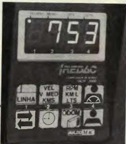
Uma interface lê as informações da memória móvel do Redac-2000
