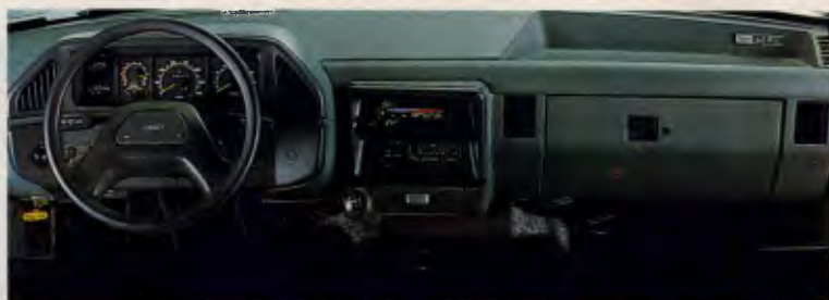
Conjunto de instrumentos integrado. Novo sistema de iluminação para melhor visibilidade. Alarmes luminosos e sonoros para baixa pressão de óleo e alta temperatura do líquido de arrefecimento.
