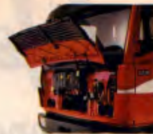
Itens de fácil acesso para manutenção e inspeção diárias mais rápidas.
