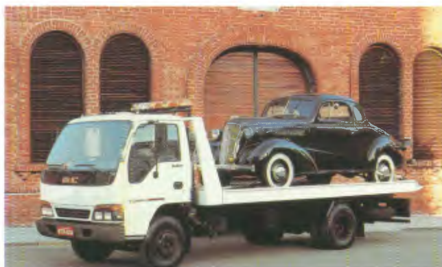
Modelo: 7-110, 4x2 Entre-eixos: 3.380 mm, 3.830 mm Motor: Isuzu 4HF1, 106 cv PBT: 6.700 kg
