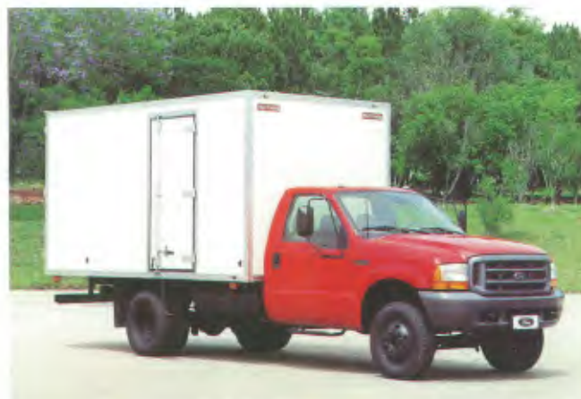
Modelo: F-4000, 4x2 Entre-eixos: 4.186 mm Motor: Cummins 4BTAA, 135 cv PBT: 6.800 kg
