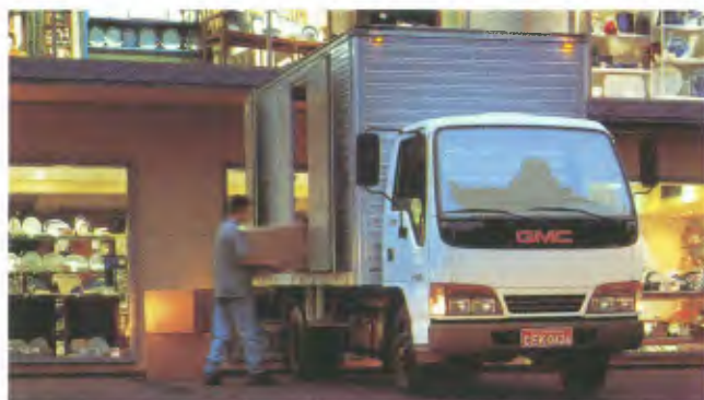
Modelo: 5-90, 4x2 Entre-eixos: 3.360 mm Motor: Isuzu 4JG2, 90 cv PBT: 5.020 kg
