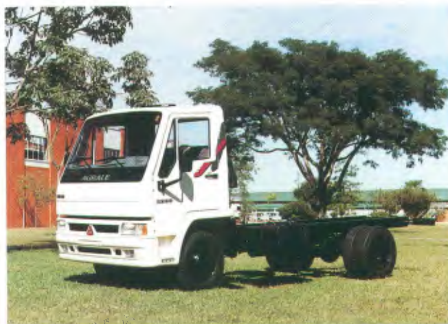
Modelo: 6000, 4x2 Entre-eixos: 3.350 mm Motor: MWM Sprint 4.07 TCA, 131 cv PBT: 6.300 kg
