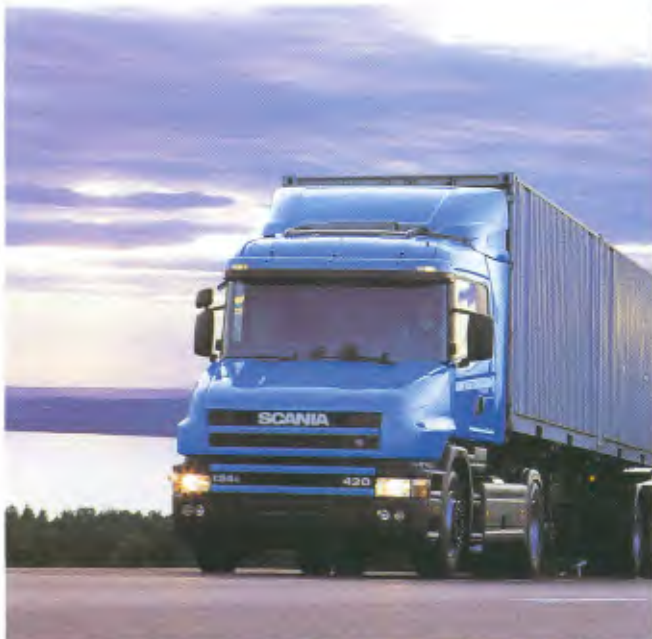
Modelo: T 124 GA 4x2 NZ Entre-eixos: 3.550 mm, 4.300 mm Motor: DSC12 01, 360 cv, DSC12 05, 420 cv PBT: 18.200 kg, 19.700 kg
