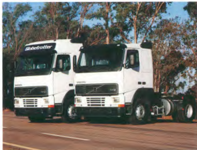
Linha FH apresenta piso plano, altura interna de 1,93 m, e versões sem cama, com uma cama e com beliche. O sobre-teto acompanha o modelo Globetrotter.
