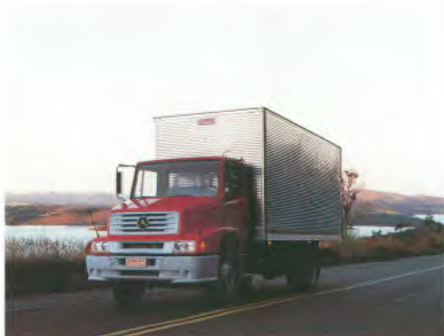
Modelo: L-1418, 4x2 Entre-eixos: 5.170 mm Motor: OM-366 A, 170 cv PBT: 13.500 kg
