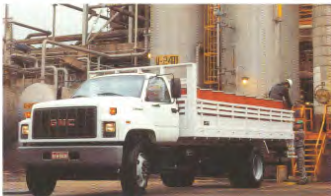
Modelo: 12-170, 4x2 Entre-eixos: 4.440 mm, 5.350 mm Motor: Caterpillar 3116, 172 cv PBT: 12.300 kg
