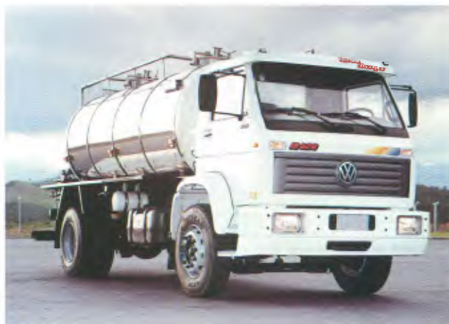
Modelo: 16-220, 4x2 Entre-eixos: 3.560 mm, 4.340 mm, 4.800 mm Motor: Cummins 6CTAA, 215 cv PBT: 16.000 kg
