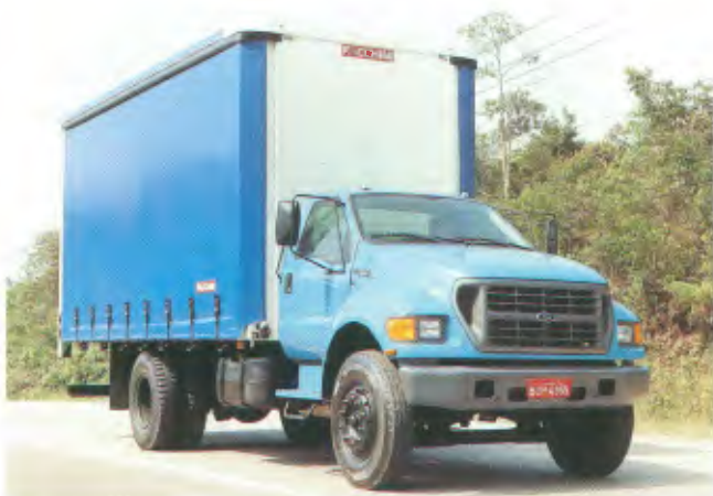
Modelo: F-14000, 4x2 Entre-eixos: 5.240 mm, 5.970 mm, 6.700 mm Motor: Cummins 6BTAA, 162 cv e 208 cv PBT: 14.100 kg
