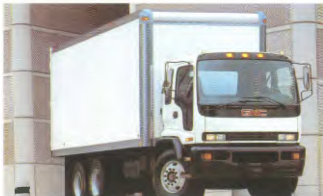
Modelo: 15-190, 4x2 Entre-eixos: 5.080 mm Motor: Caterpillar 3116 Hevi, 188 cv PBT: 15.000 kg
