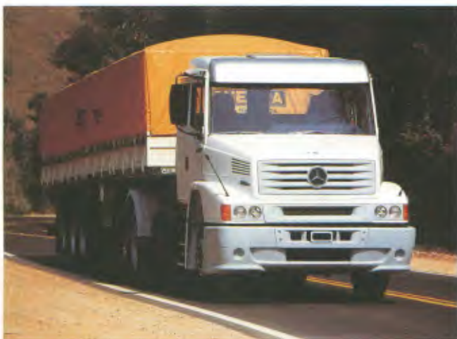
Modelo: LS-1632, 4x2 Entre-eixos: 4.500 mm Motor: OM-449 LA, 320 cv PBT: 15.500 kg, 22.000 kg
