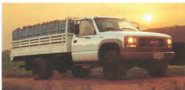
Modelo: 6-150, 4x2 Entre-eixos: 4.050 mm Motor: MWM 6.07 THD, 148 cv PBT: 6.300 kg
