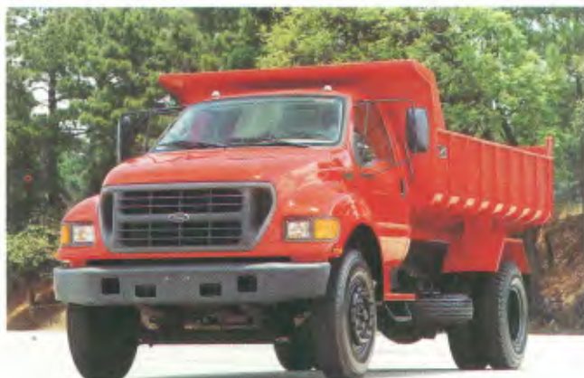
Modelo: F-16000, 4x2 Entre-eixos: 4.470 mm, 4.928 mm, 5.385 mm Motor: Cummins 6BTAA, 208 cv PBT: 15.870 kg
