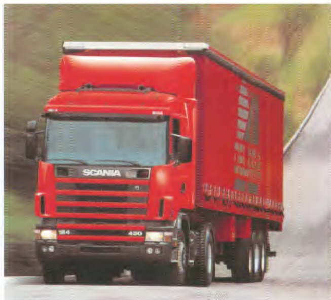
Modelo: R 124 LA 4x2 NA Entre-eixos: 3.550 mm, 4.300 mm Motor: DSC12 02, 360 cv, DSC12 05, 420 cv PBT: 19.700 kg
