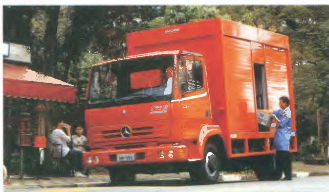
Modelo: 712 C, 4x2 Entre-eixos: 3.150 mm, 3.700 mm Motor: OM-904 LA, 122 cv PBT: 7.700 kg
