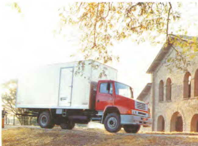
Modelo: L-1218 R, 4x2 Entre-eixos: 5.170 mm Motor: OM-366 A, 170 cv PBT: 12.300 kg, 19.000 kg
