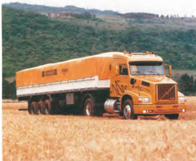
Modelo: NL EDC GOLD Entre-eixos: 3.800 mm, 4.250 mm, 4.600 mm, 5.400 mm, 5800 mm Motor: TD123E, 356 cv PBT: 18.500 kg, 19.700 kg (opcional)
