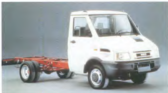
Modelo: Daily Chassi Cabine 35.10, 4x2 Entre-eixos: 3.300 mm, 3.600 mm Motor: Iveco 8140.23, 103 cv PBT: 4.000 kg
