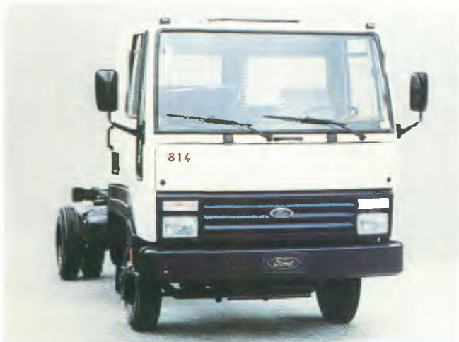
Modelo: Cargo 814, 4x2 Entre-eixos: 3.300 mm, 3.900 mm Motor: Cummins 4BTAA, 140 cv PBT: 7.700 kg
