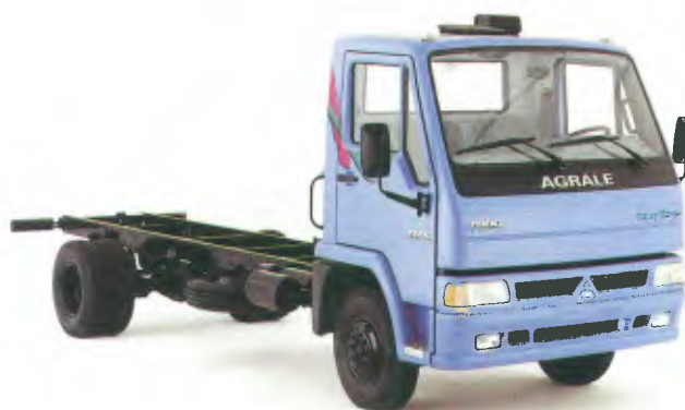
Modelo: 7500, 4x2 Entre-eixos: 3.500 mm, 4.200 mm Motor: MWM 4.10T, 135 cv PBT: 7.000 kg
