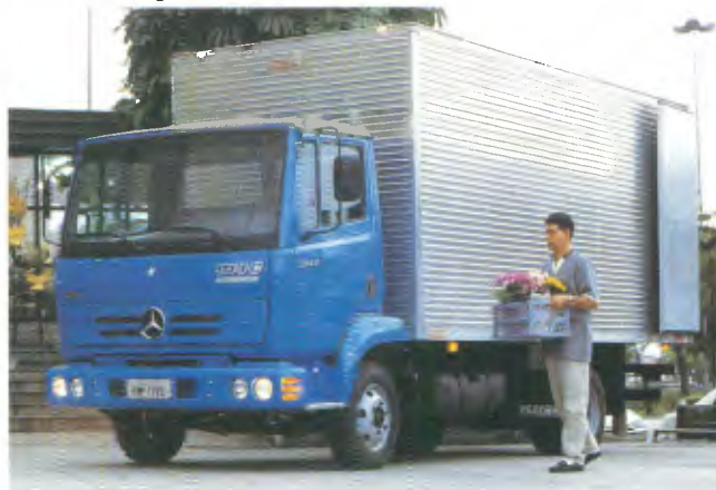
Modelo: 914 C, 4x2 Entre-eixos: 3.750 mm Motor: OM-904 LA, 136 cv PBT: 9.100 kg
