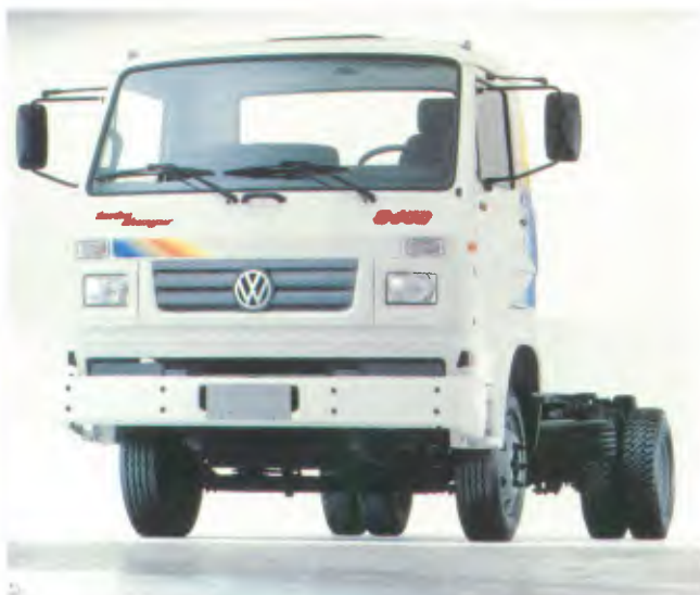
Modelo: 8-140, 4x2 Entre-eixos: 3.300 mm, 3.900 mm Motor: MWM 4.10T, 135 cv PBT: 7.700 kg
