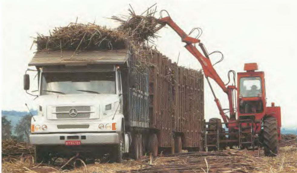
Modelo: L-2638, 6x4 Entre-eixos: 5.350 mm + 1.450 mm Motor: OM-457 LA, 380 cv PBT: 33.100 kg
