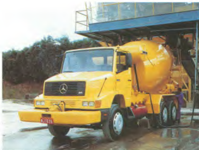
Modelo: 2325, 6x4 Entre-eixos: 5.170 mm + 1.350 mm Motor: OM-449 A, 252 cv PBT: 22.500 kg
