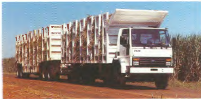
Modelo: Cargo 2630, 6x4 Entre-eixos: 3.440 mm, 4.580 mm Motor: Cummins 6CTAA, 291 cv PBT: 23.000 kg
