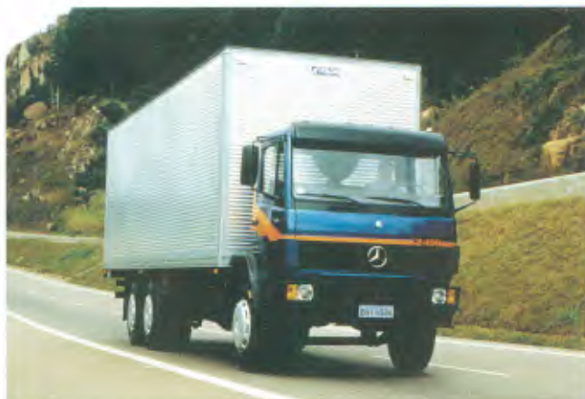
Modelo: 2418, 6x4 Entre-eixos: 4.830 mm + 1350 mm Motor: OM-366 A, 184 cv PBT: 23.500 kg
