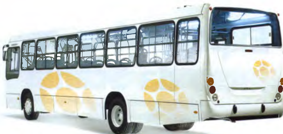
Saias laterais externas são compostas por painéis móveis para facilitar a manutenção
