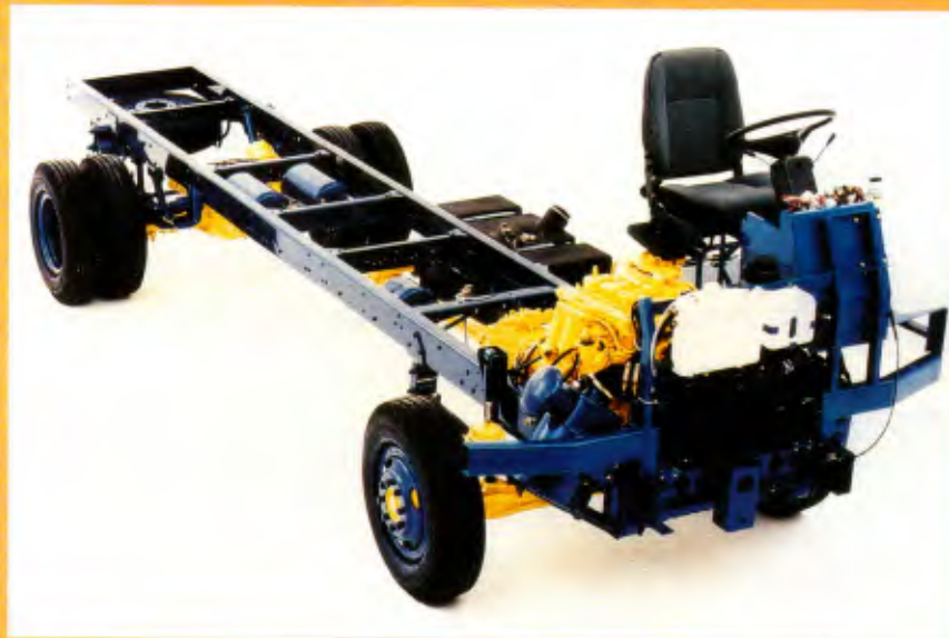
O chassi MA 6.0: câmbio automático, suspensão pneumática e embreagem com acionamento hidráulico
