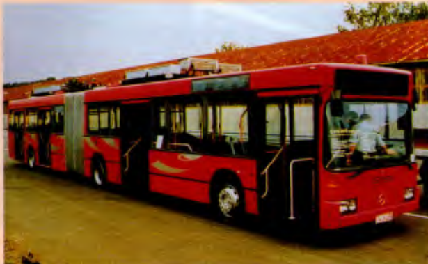
O ônibus-conceito EEDrive, em teste na Alemanha, é menos poluente e funciona com energia elétrica
