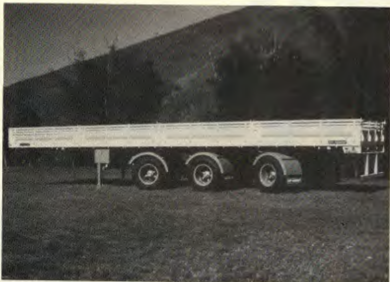
A plataforma FNV transporta 45 t garantidas por eixos traseiros mais distantes
