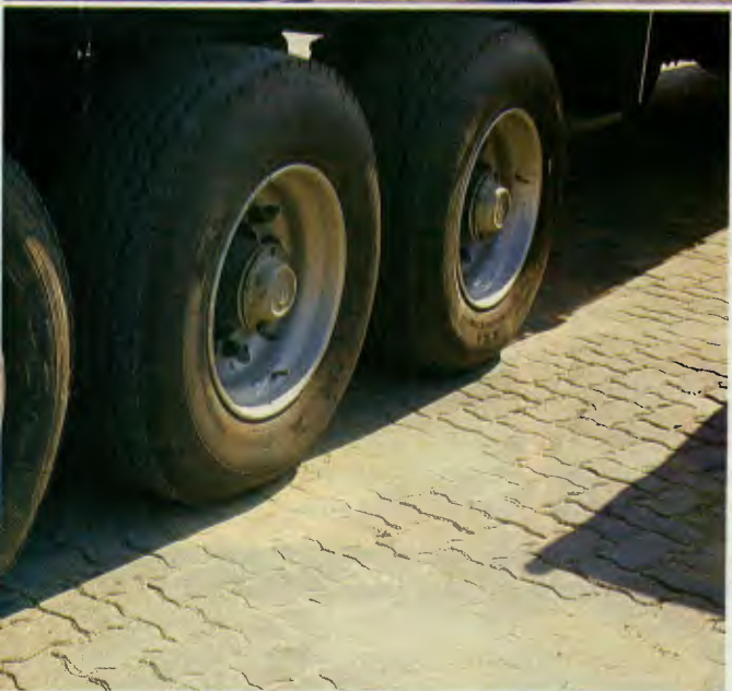
Semi-reboque com plataforma transportando vidros foi testado na Via Dutra; pneus singles, suspensão a ar e rodas de alumínio fizeram parte do equipamento
