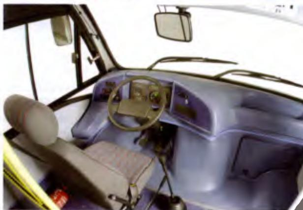
Devido ao posicionamento do motor que não invade o interior do veículo, os níveis de ruído e de calor na cabine e no salão de passageiros são “muito menores do que os dos seus concorrentes”. A solução também facilita a circulação, aumenta o espaço interno e permite ao motorista acessar diretamente seu posto de condução. No lado externo, o acesso para manutenção
