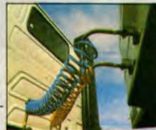
• O tubo reforçado TECALON série 102-TB, é o verdadeiro substituto dos tubos metálicos no circuito de freio a ar, oferecendo inúmeras vantagens, motivo pelo qual é utilizado por todas as montadoras de carretas, ônibus e caminhões.
