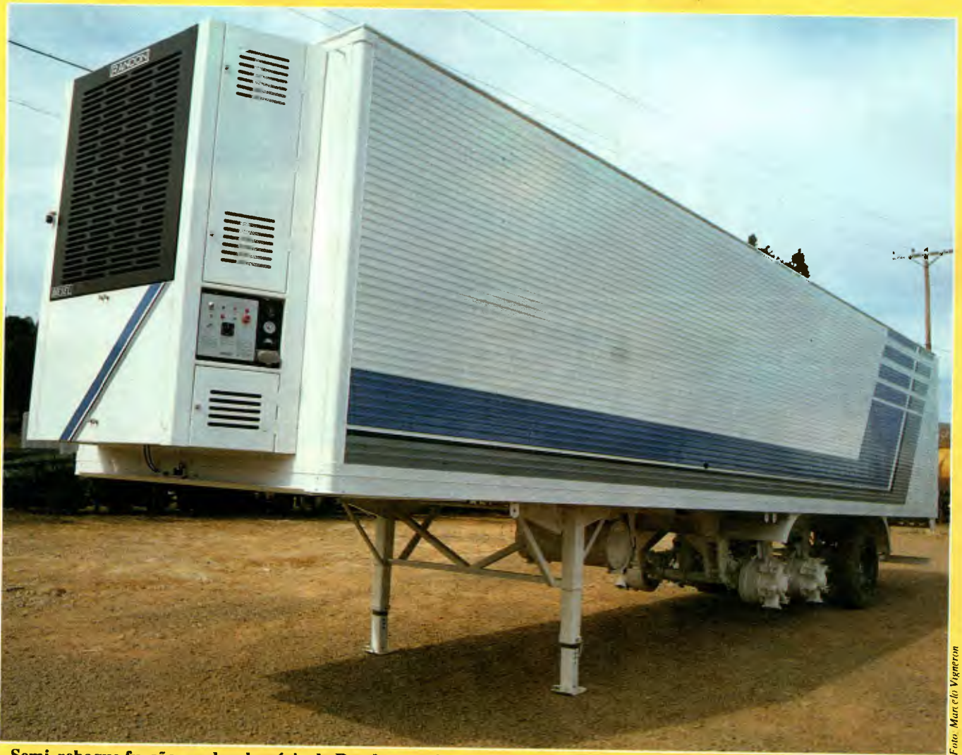
Semi-reboque furgão em duralumínio da Randon movimenta perecíveis e frigorificados à prova de umidade e corrosão
