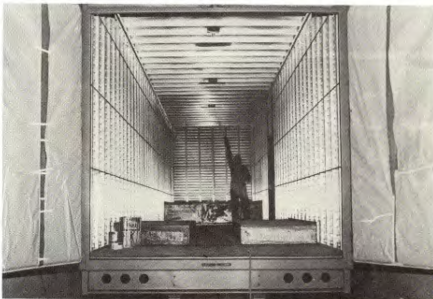
Teto em fibra de vidro, sem massa calafetada, impede infiltração de água
