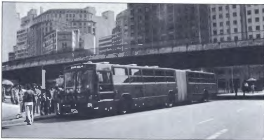
Carroçaria Caio sobre chassi B-58 marca a estréia da Volvo no Brasil.
