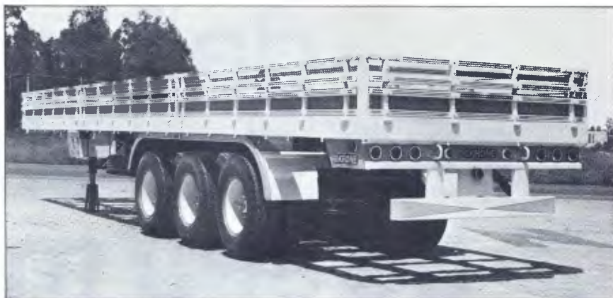
Semi-reboque Krone: peso total menor, viga sem solda e freios originais.
