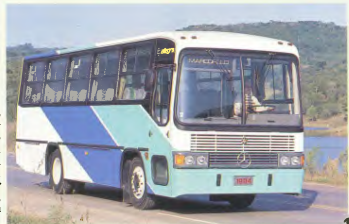
Carroceria/Carrocería /Body: Allegro Aplicação/Aplicación/Use: Interurbano/Interurbano/Intercity Estrutura/Estructura /Structure: Aço galvanizado/Acero galvanizado/Galvanised steel Largura/Ancho/Width: 2,54 m Comprimento/Largo/Length: 12,00 m Chassis que podem ser encarroçados/Chasis que pueden ser ensamblados/Embodiment-feasible chassis: Scania, Volvo, Mercedes-Benz, Ford e Volkswagen
