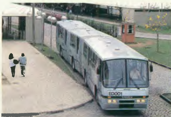
Chassi-modelo/Chasi-modelo/Chassi model: B58 Bi-Articulado Motor-potência/Motor-potencia/Engine power: THD 101 KB/286 cv. Entre-eixos/Distancia entre los ejes/ Wheelbase: 5,50 m
