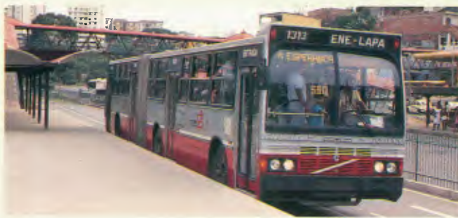
Chassi-modelo/Chasi-modelo/Chassi model: B58 Articulado Motor-potência/Motor-potencia/Engine power: THD 101 GC/250 cv. Peso do chassi/Peso del chasi/Chassi weight: 7.930 kg Entre-eixos/Distancia entre los ejes/ Wheelbase: 5,50 m
