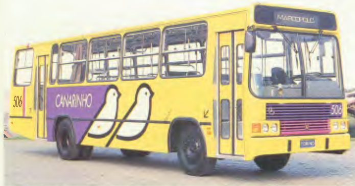
Carroceria/Carrocería/Body: Torino Aplicação/Aplicación/Use: Urbana/Urba/Urban Estrutura/Estructura/Structure: Aço galvanizado/Acero galvanizado/Galvanised steel Largura/Ancho/Width: 2,54 m Comprimento/Largo/Length: 13,20 m Chassis que podem ser encarroçados/Chasis que pueden ser ensamblados/ Embodiment-feasible chassis: Mercedes-Benz, Scania, Volvo, Ford, Volkswagen
