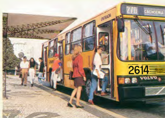
Chassi-modelo/Chasi-modelo/Chassi model: B58 Urbano Motor-potência/Motor-potencia/Engine power: THD 101 GG/250 cv. Entre-eixos/Distancia entre los ejes/ Wheelbase: 6,00m
