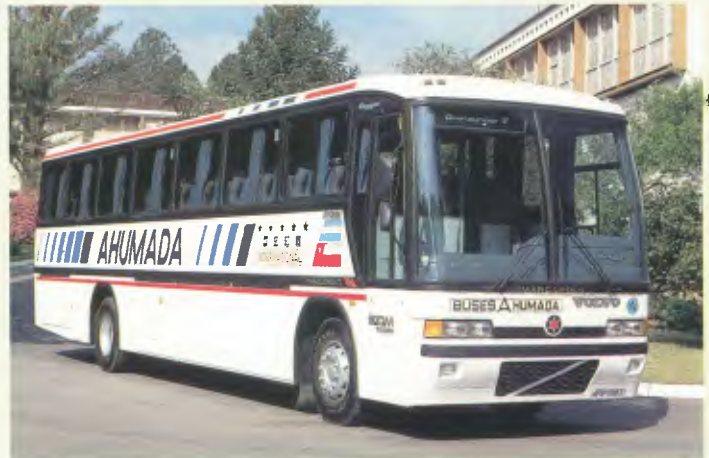
Carroceria/Carrocería /Body: Viaggio GV 1000 Aplicação/Aplicación/Use: Rodoviária/Para carretera/Coach Estrutura/Estructura /Structure: Aço galvanizado/Acero galvanizado/ Galvanised steel Largura/Ancho/Width: 2,54 m Comprimento/Largo/Length: 12,00 m Chassis que podem ser encarroçados/Chasis que pueden ser ensamblados/Embodiment-feasible chassis: Scania, Volvo, Mercedes-Benz, Ford e Volkswagen
