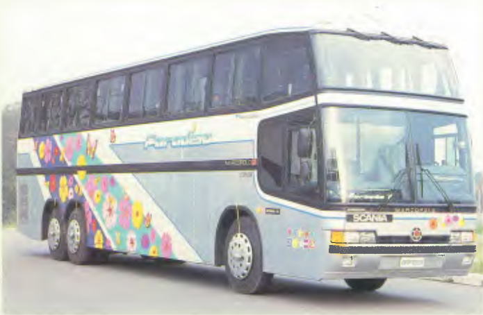
Carroceria/Carrocería /Body: Paradiso GV 1450 Aplicação/Aplicación/Use: Rodoviária/Para carretera/Coach Estrutura/Estructura /Structure: Aço galvanizado/Acero galvanizado/Galvanised steel Largura/Ancho/Width: 2,60 m Comprimento/Largo/Length: 13,20 m Chassis que podem ser encarroçados/Chasis que pueden ser ensamblados/Embodiment-feasible chassis: Scania/Volvo/ Mercedes-Benz.
