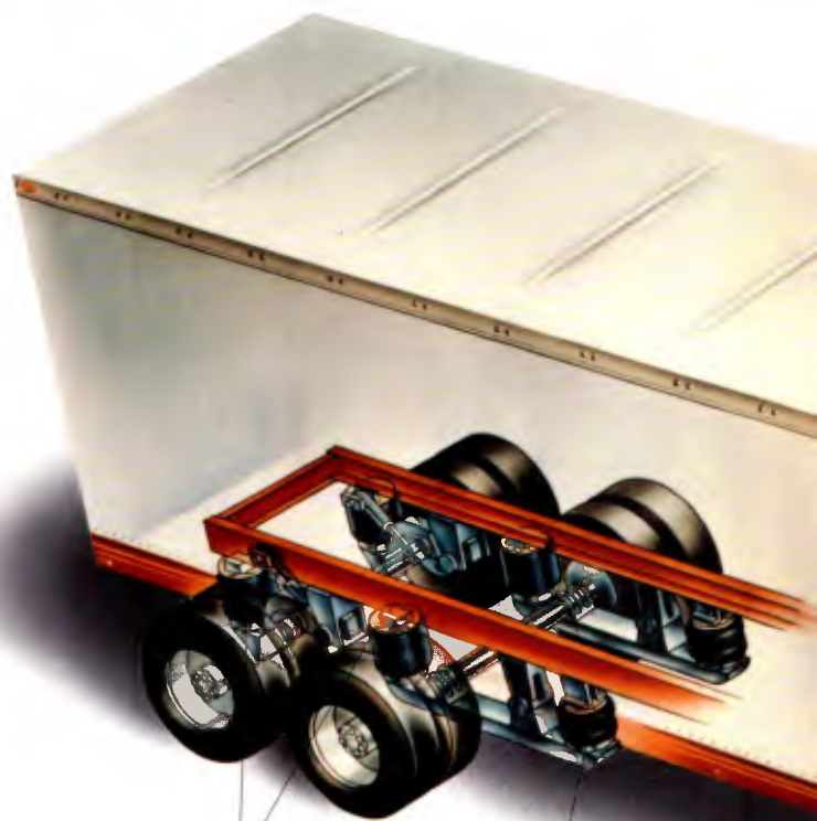
SUSPENSÃO PRIMÁRIA DO TRAILER molas pneumáticas
