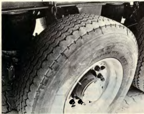
O pneu em teste é calibrado com 120 psi
