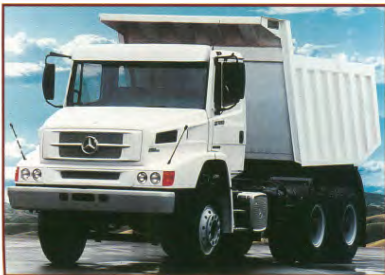
Modelo: LK-2638 Entre-eixos: 3.950 mm + 1.450 mm Motor: OM-457 LA, 280 kW, 380 cv PBT: 33.100 Kg
