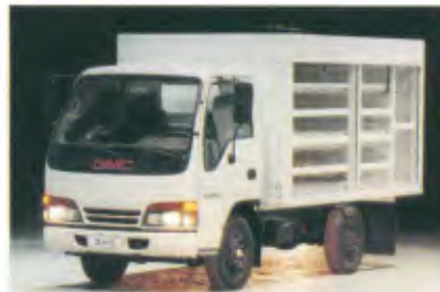
O VUC 5-90, da GMC: menor distância entreeixos para trafegar em zonas com restrição de circulação para veículos de grande porte
