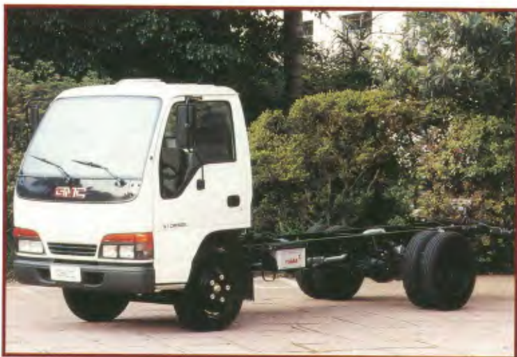
Modelo: 5-90 Entre-eixos: 3.360 mm Motor: ISUZU-4JG2, 4 cilindros, 83 cv, 3.400 rpm PBT: 5.020 Kg
