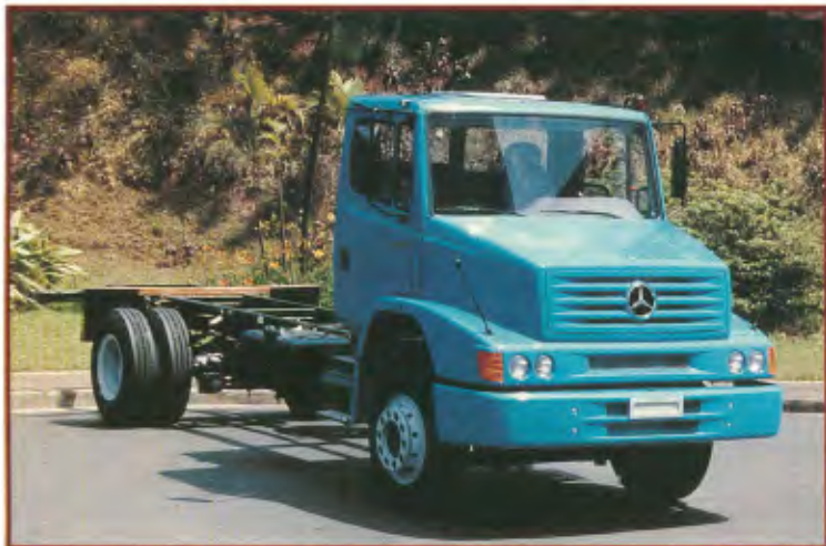
Modelo: L-1620 Entre-eixos: 5.170 Motor: OM-366 LA, 155 kW, 211 cv PBT: 15.500 Kg, 22.000 Kg
