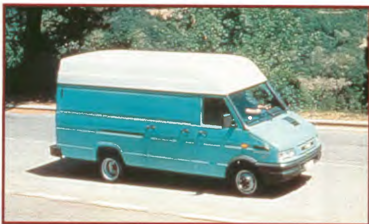
Modelo: Daily 35.10 Furgão Entre-eixos: 3.300 mm Motor: Iveco 8140, 103 cv, 3.600 rpm PBT: 4.000 Kg
