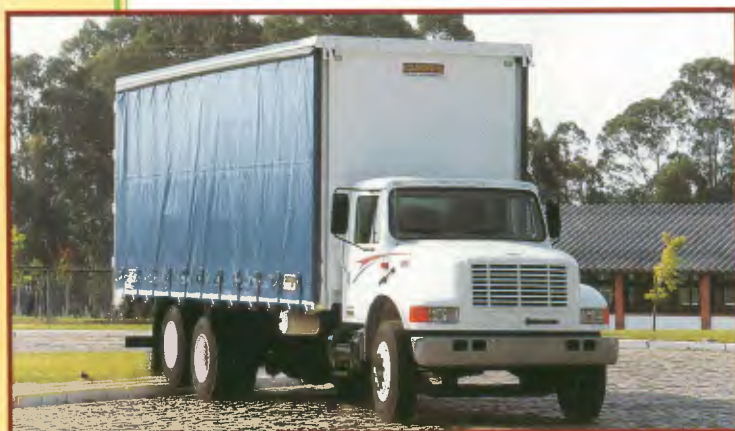
Modelo: 4900 4x2 Entre-eixos: 5.994 mm Motor: International DT 466 E, eletrônico, 250 cv, 2300 rpm PBT: 16.000 Kg
