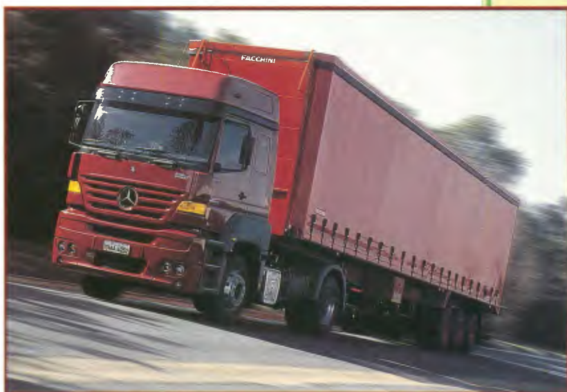
Modelo: LS-1938 Entre-eixos: 4.600 mm Motor: OM-457 LA, 280 kW, 380 cv PBT: 19.500 Kg
