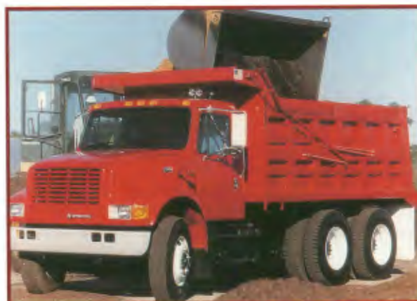
Modelo: 4900 6x4 Entre-eixos: 4.572 mm Motor: International DT 466 E, eletrônico, 250 cv, 2300 rpm PBT: 23.000 Kg
