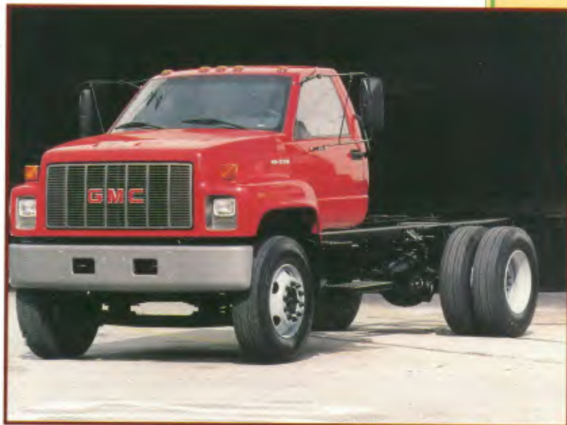
Modelo: 16-220 Entre-eixos: 4.440 mm, 5.350 mm Motor: Caterpillar-3116, 6 cilindros, 218 cv, 2.600 rpm PBT: 16.000 Kg
