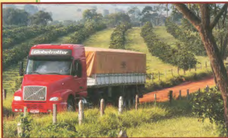
Modelo: NH12 380/420 4x2 Entre-eixos: 4.000 mm, 4.300 mm, 4.600 mm, 5.600 mm, 5.800 mm Motor: D12C380, 380 cv; D12C420, 420 cv PBT: 19.000 Kg
