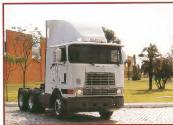
Modelo: 4900 6x4 Entre-eixos: 4.572 mm Motor: International DT 466 E, eletrônico, 250 cv, 2300 rpm PBT: 23.000 Kg
