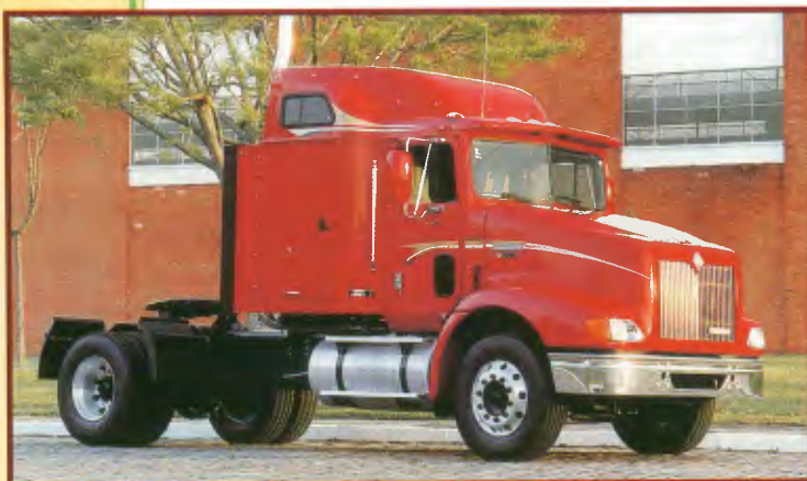
Modelo: 9.200 4x2 Entre-eixos: 4.902 mm Motor: Cummins ISM 380E, eletrônico, 380 cv, 1.900 rpm PBT: 16.000 Kg
