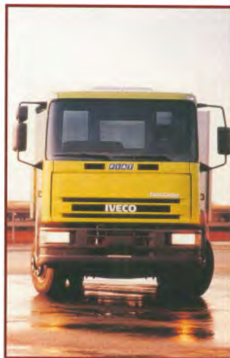
Modelo: Eurocargo 160.E 21 Entre-eixos: 4.815 mm Motor: Iveco 8060.45A, 207 cv, 2.700 rpm PBT: 16.000 Kg
