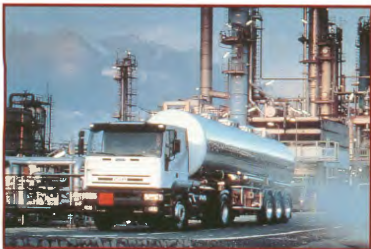
Modelo: Eurotech 450.E 37T Entre-eixos: 3.800 mm Motor: Iveco 8210, 370 cv, 1.900 rpm PBT: 20.000 Kg
