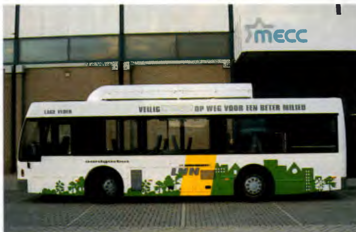
Botijões de gás no teto seriam substituídos por reboque
