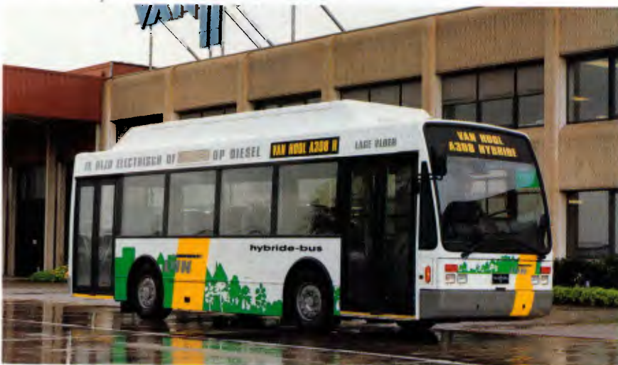
Van Hool A308H híbrido, alimentado por bateria ou gerador a diesel
