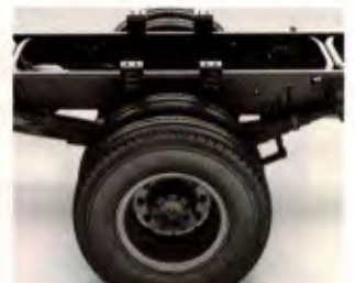
Suspensão extra-resistente, com molas mais longas e terceiro estágio de borracha.
