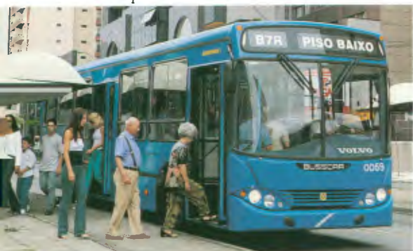
O B7R piso baixo, da Volvo: altura de 300 mm a 420 mm do solo e início das vendas em abril deste ano
