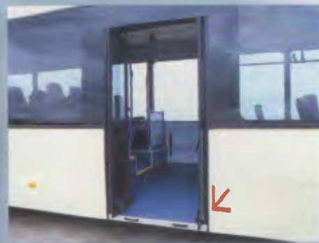
Porta central com rampa e sem degraus.
