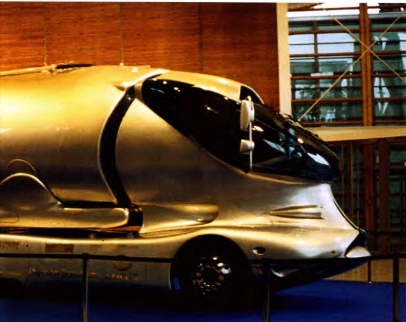
a granel leva o nome de Spitzer-Colani. O veículo consiste em um tanque basculante modelo SK 2760 CAL com volume de aproximadamente 60 m<sup>3</sup> e um caminhão trator Mercedes-Benz Actros Mega Space, 1843 LS, 4x2, com entre-eixos de 3.600 mm e cabine longa. O conjunto, com desenho futurista, foi projetado para pbtcc de 40 t e seu desenvolvimento levou um ano.
