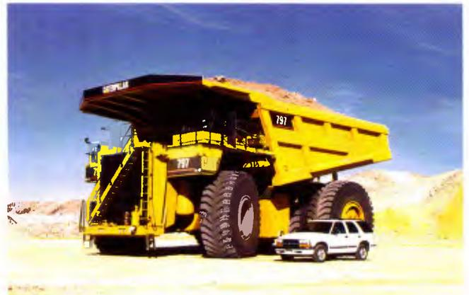
*Pneu gigante Michelin, com 3,89 m de diâmetro e 4,8 t de peso em caminhão de mineração*
