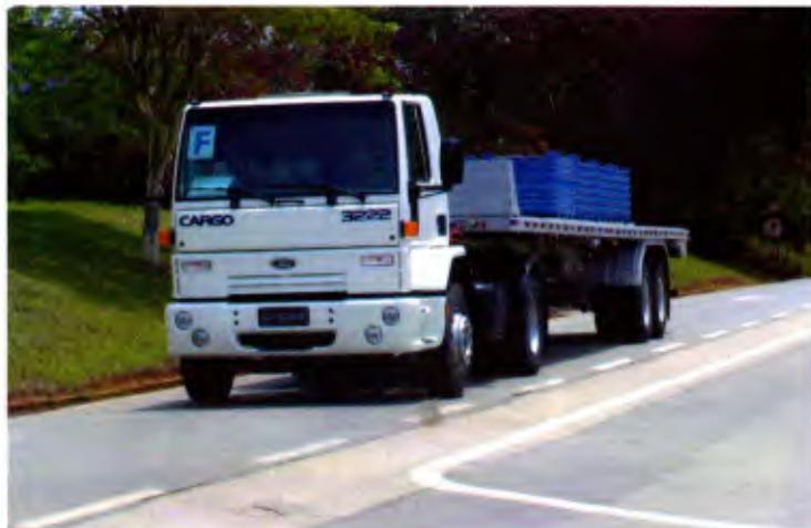
*Novo cavalo-mecânico C-3222, para semi-reboques*
