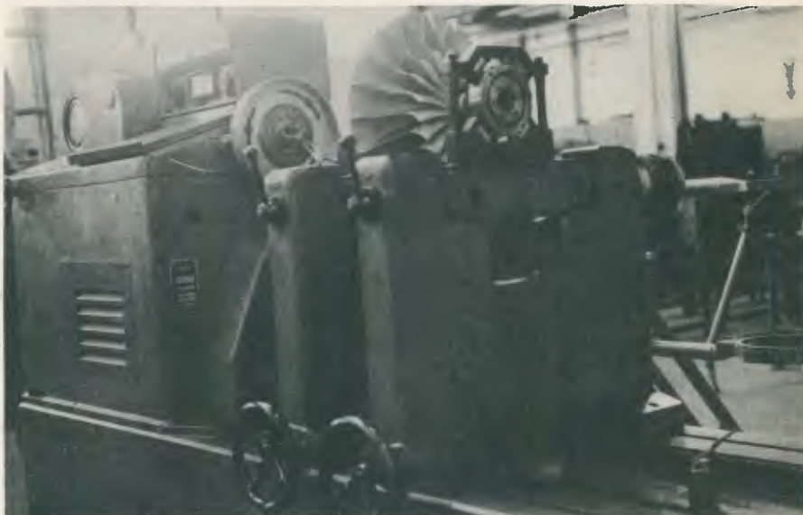
O funcionamento perfeito da turbina depende do seu adequado balanceamento.
