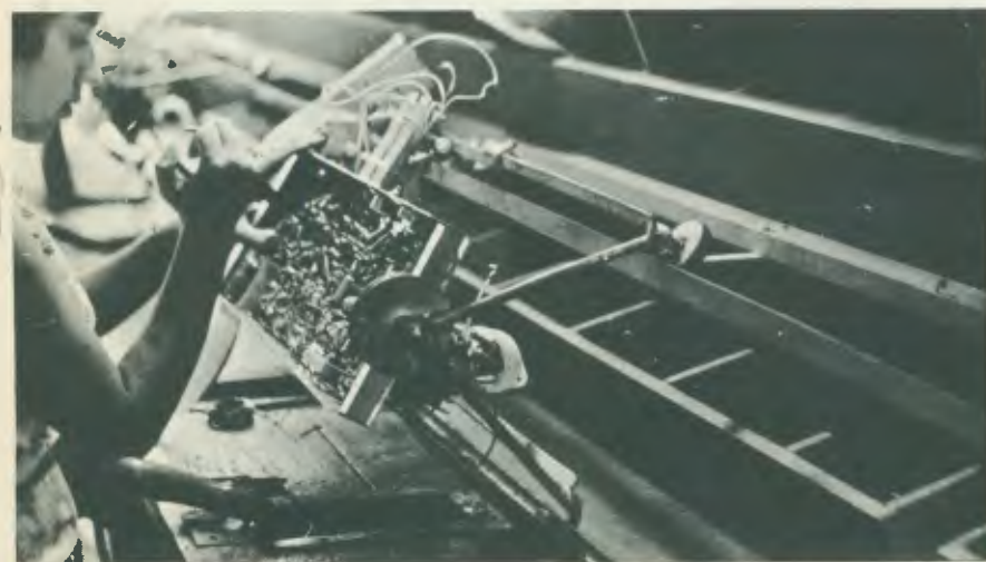
Chassis de televisão são transportados em carrinhos de trajetória fixa.
