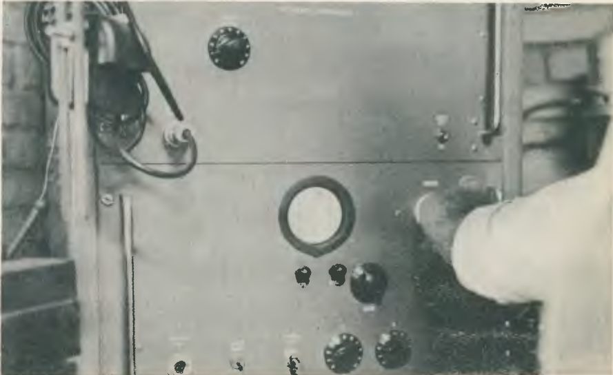
Todas as palhetas das turbinas passam por este comparador de frequência.
