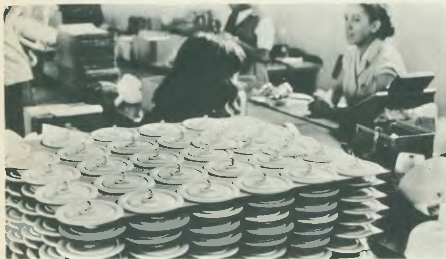
Os materiais devem ficar ao fácil alcance da montadora, ao longo da linha.
