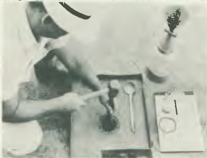
Teste para verificação da densidade na base do pavimento: furo cilíndrico.
