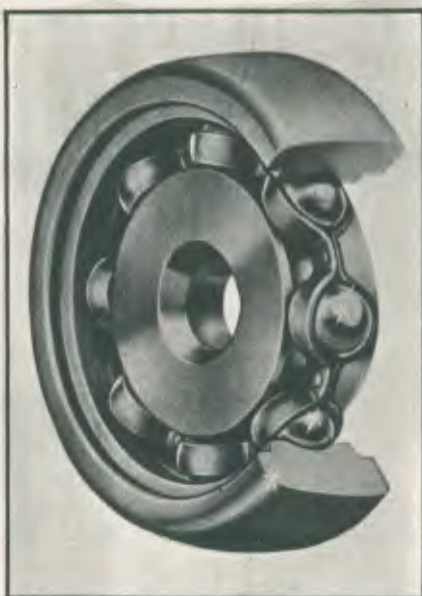
Os rolamentos utilizados nos "trolleys" possuem esferas de alta precisão.
