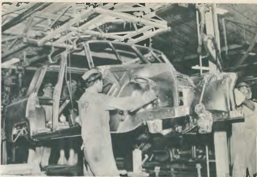
Talhas em monovias movimentam automóveis ao longo da linha de montagem.
