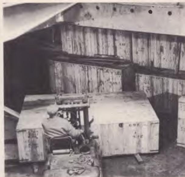
O dispositivo permite a operação em porões de navios.
