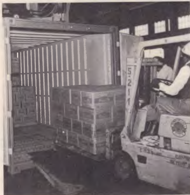
O piso de aço resiste melhor ao peso das empilhadeiras.
