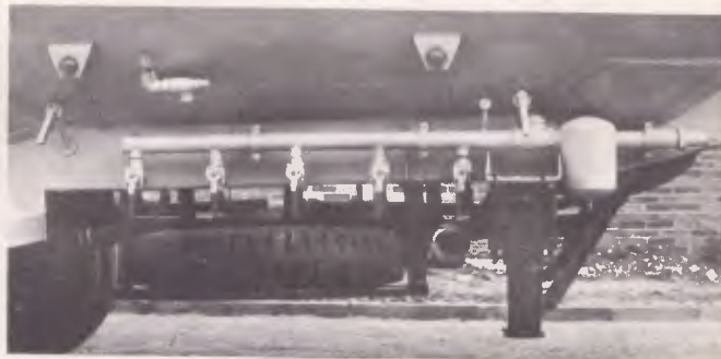
"Comandos do sistema de escoamento sob pressão".
