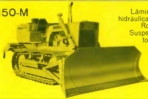
Lâmina com angulação hidráulica. 105 H.P. Contra-Rotação de esteiras. Suspensão por barra de torção. Transmissão Power Shift, Escarificador hidráulico.
