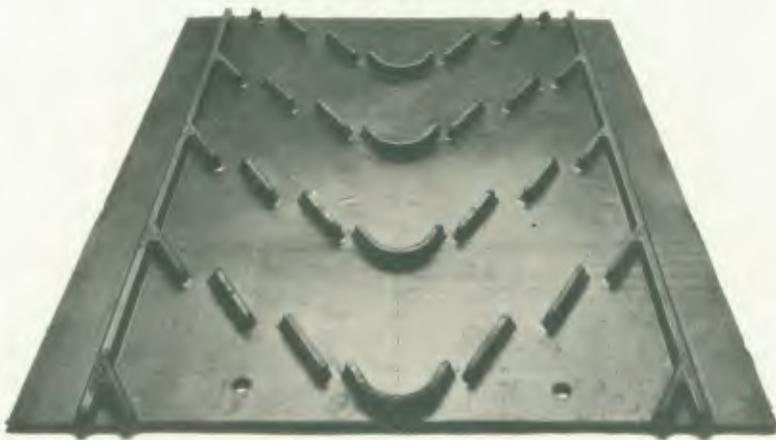
Correia com taliscas em diagonal (taliscas padronizadas com 15 mm de altura, com proteção lateral para transporte e elevação de materiais granulados, cavacos, etc.)
