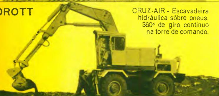
CRUZ-AIR - Escavadeira hidráulica sobre pneus. 360° de giro contínuo na torre de comando.
