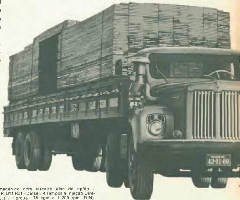
**MODÉLDS:** "L" Caminhão ou cavalo mecânico / "LS" Caminhão ou cavalo mecânico com terceiro eixo de apoio / "LT" Caminhão ou cavalo mecânico com tração também no terceiro eixo. **MOTDR:** D11 R01 - Diesel, 4 tempos a Injeção Direta / 6 cilindros. Potência a 2.200 rpm / 195 C.V. (DIN) 210 H.P. (S.A.E.) / Torque 76 kgm a 1.200 rpm (DIN).
