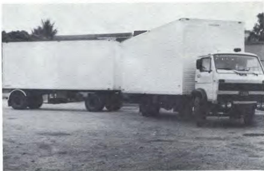
O conjunto tem 18,95 m de comprimento; os baús, capacidade para 110 m<sup>3</sup>
