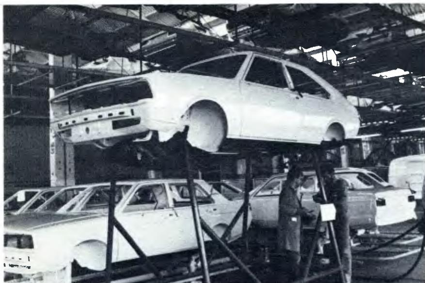
Após a aplicação de esmalte, seco a 140°C, vem a inspeção final
