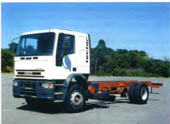
O médio EuroCargo tem motor com novo sistema de injeção e limitador de velocidade
