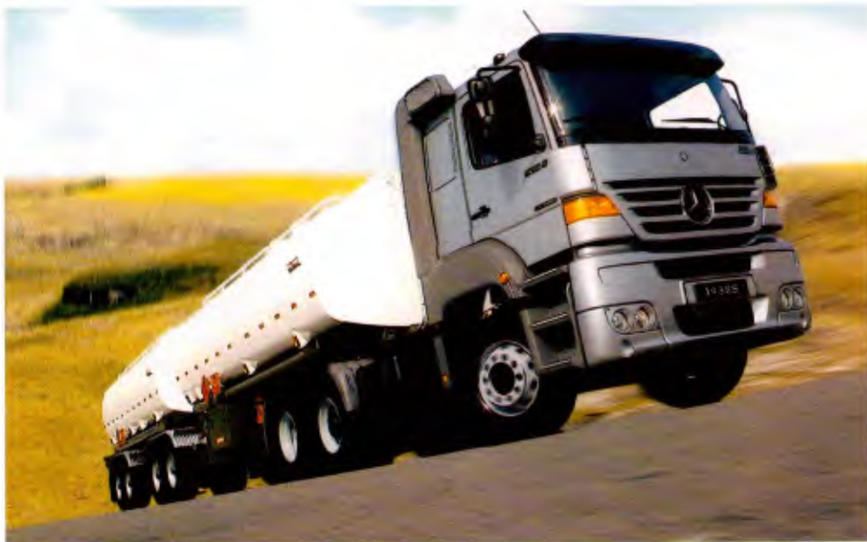
Cavalo-mecânico 1938 S: agora com terceiro eixo de fábrica
