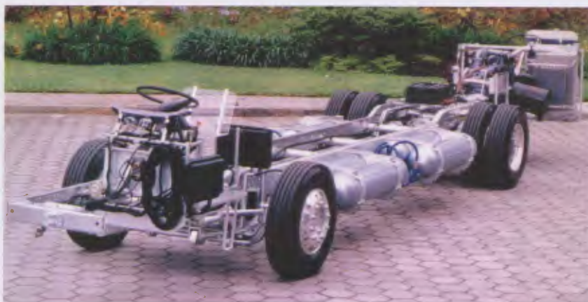
Chassi de ônibus Mercedes-Benz com motor a gás da terceira geração
