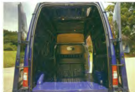
Na opção com chassi curto e teto médio, a Transit tem peso bruto total de 3.500 kg e capacidade de carga de 1.400 kg, além da capacidade volumétrica de 7,5 m 3
