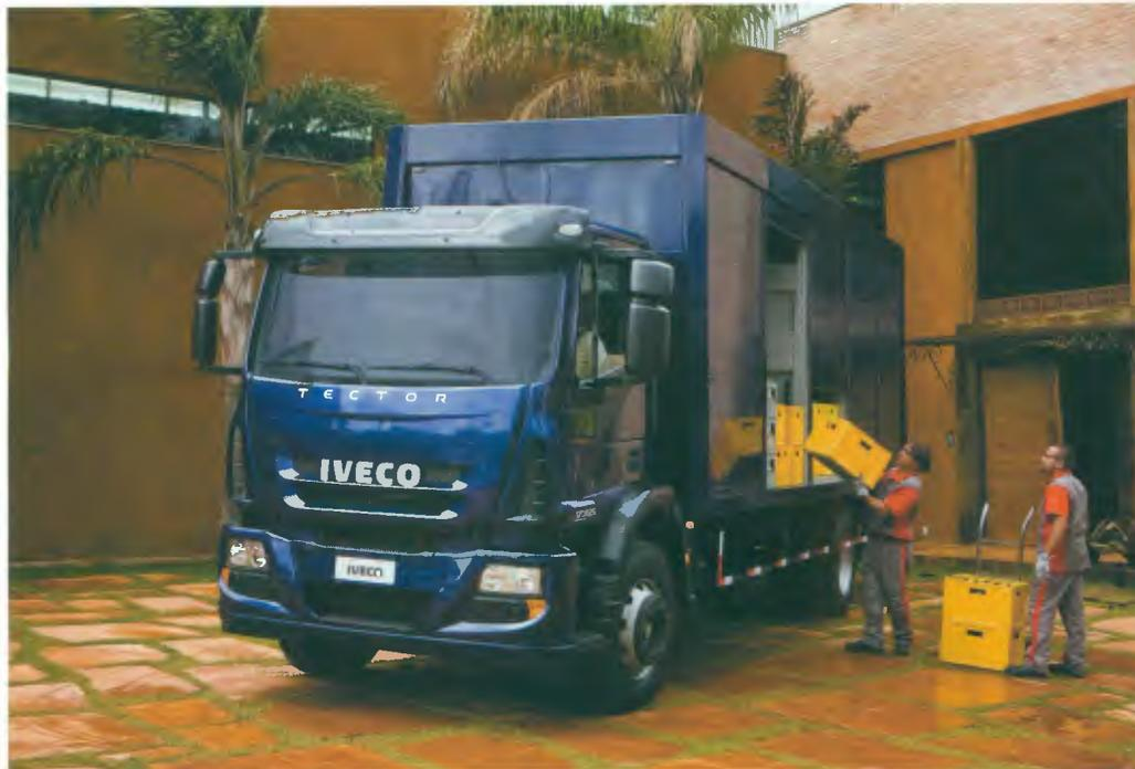
*O motor Tector é de 6 cilindros e 5,9 litros e tem 150 cv de potência com 950 Nm de torque, 17% a mais que o modelo anterior*
