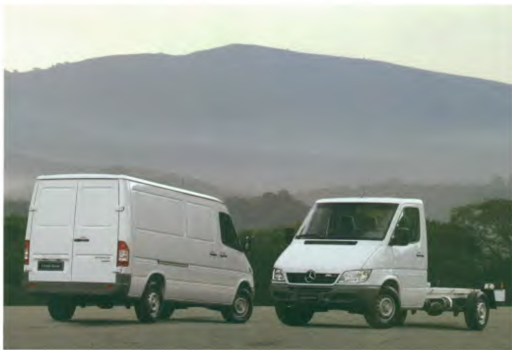
Na linha de furgões, a Mercedes agora oferece entre-eixo curto/3.000 mm ou longo/3.550 mm e chassi com entre-eixo longo
