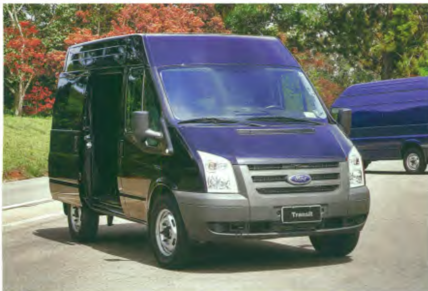
Na opção com chassi curto e teto médio, a Transit tem peso bruto total de 3.500 kg e capacidade de carga de 1.400 kg, além da capacidade volumétrica de 7,5 m 3
