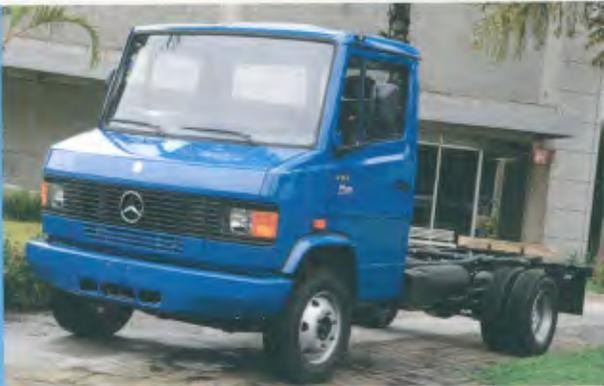
**Entre-eixos:** 3.700 / 4.250 mm ama tecedoras telescópicas de dupla ação e barra estabilizadora.
