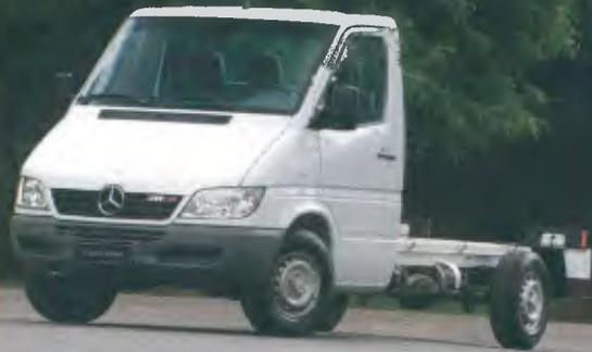
**Entre-eixos:** 3.550 mm com mola parabólica transversal. Traseira: feixe de molas parabólicas.
