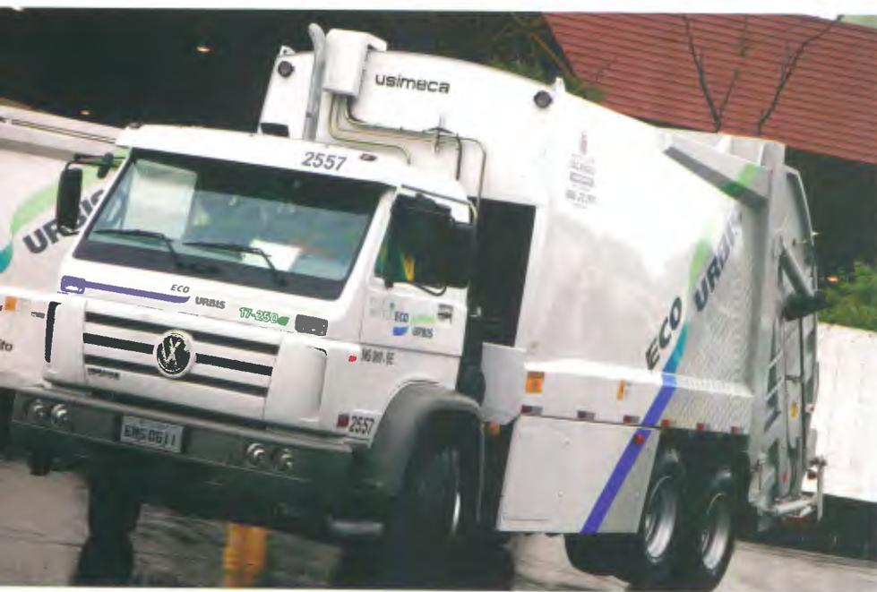
*Caminhão 6x2 da MAN-VW, desenvolvido especialmente para coleta de lixo*
