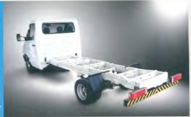
**Entre-eixos:** 3.550 / 4.025 mm com mola parabólica transversal. Traseira: feixe de molas parabólicas.
