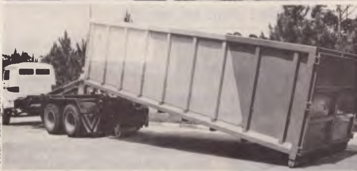
Quando a carroçaria toca o solo, desliza sobre roletes, até ser posta no chão
