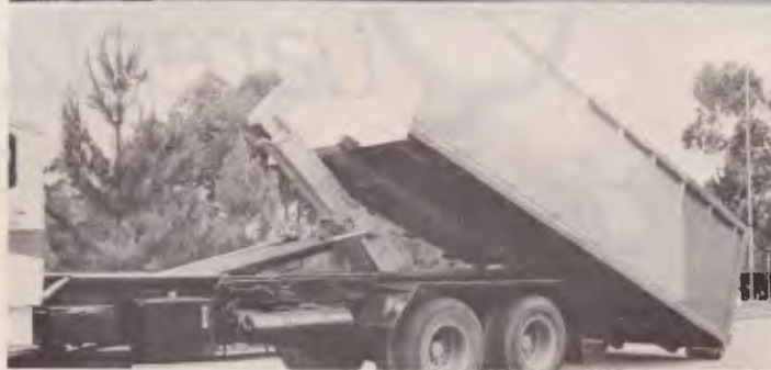
... a carroçaria, que se desloca; o braço hidráulico a levanta e a mantém presa pelo gancho.
