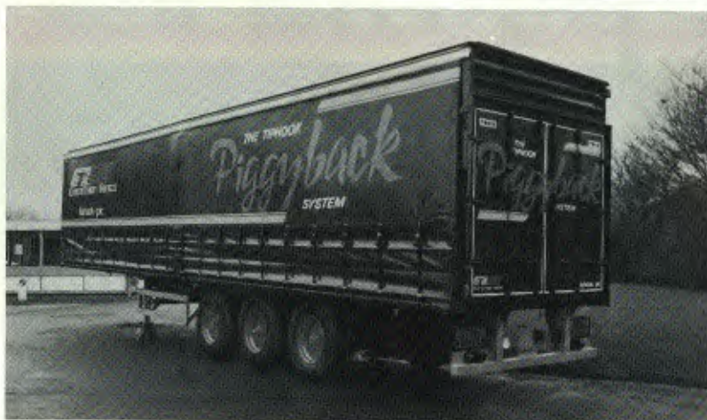
A colocação da carreta no vagão dispensa equipamentos de manuseio
