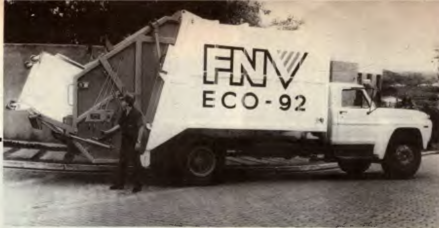
Modelos ganharam sistema hidráulico regenerativo e praça de carga para lixo solto
