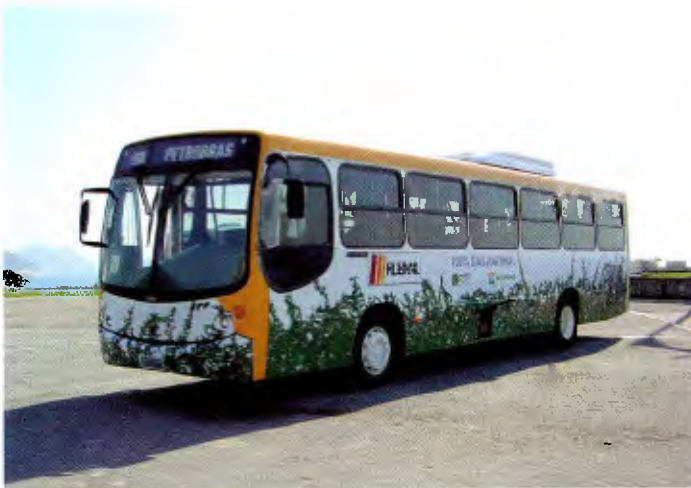
Ônibus a gás Mercedes-Benz, com carroceria Comil, para avaliar o uso de gás natural no Rio
