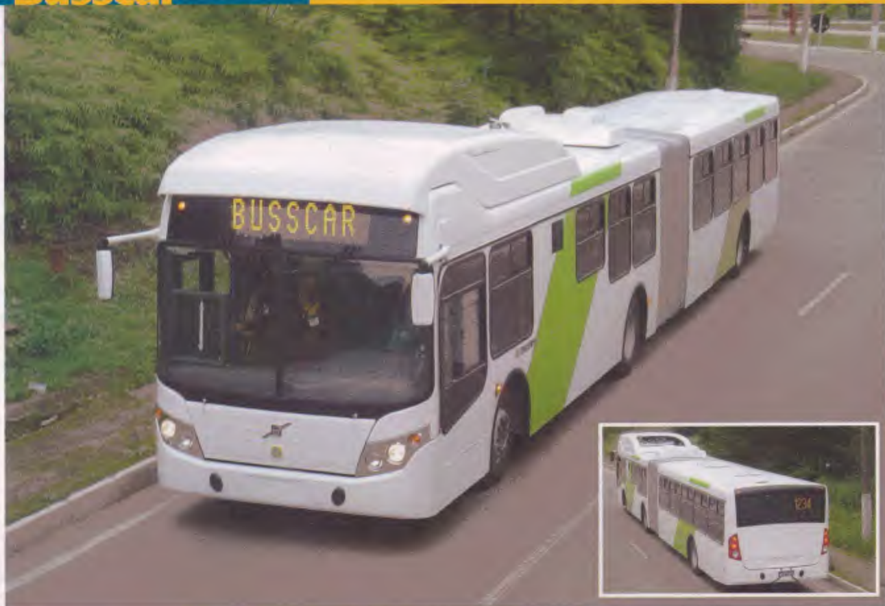
No Busscar Urbanuss Articulado que circula no sistema Transantiago o radiador está instalado na parte superior frontal do veículo
