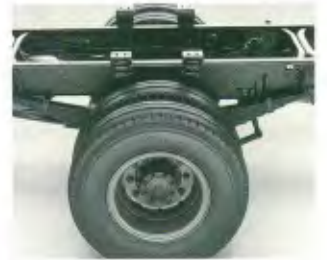
Suspensão extra-resistente, com molas mais longas + terceiro estágio de borracha.
