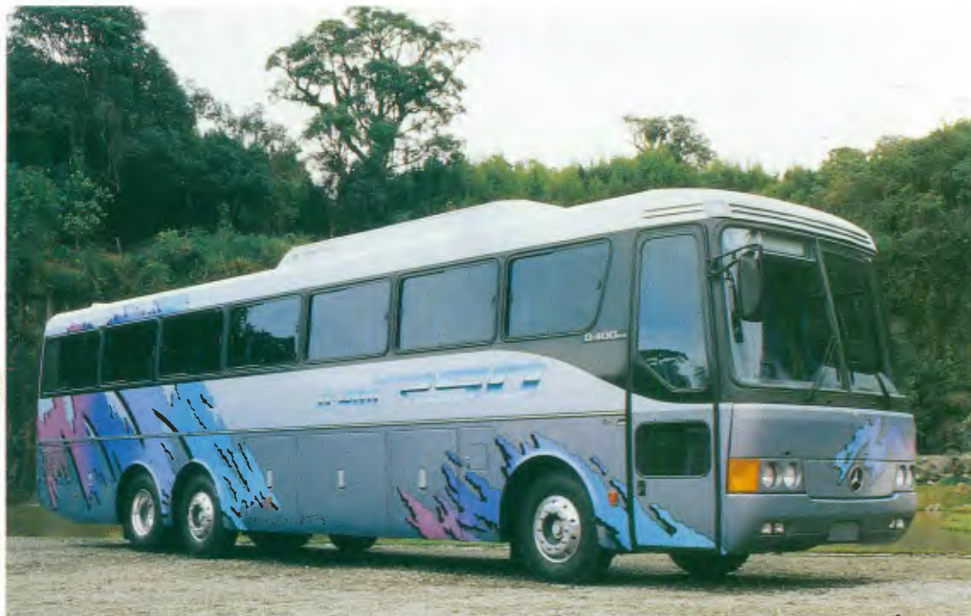
O monobloco O400 RSD (acima), 6x2, utiliza motor OM 447LA, de 354 cv, tem 13,20 m de comprimento; o chassi OH-1635 L (abaixo), com motor traseiro
