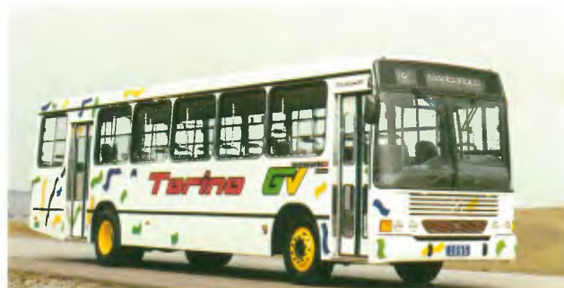
O Torino GV na versão duas portas sobre chassi Mercedes-Benz OF 1620, com 11,77 m de comprimento
