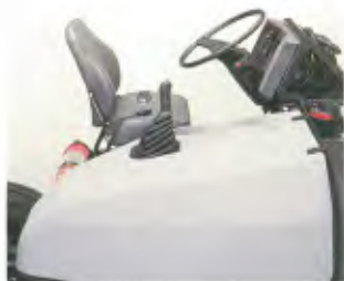
Isolamento termoacústico do motor em parede dupla com espuma de poliuretano, que garante menor ruído e maior conforto para o motorista.
