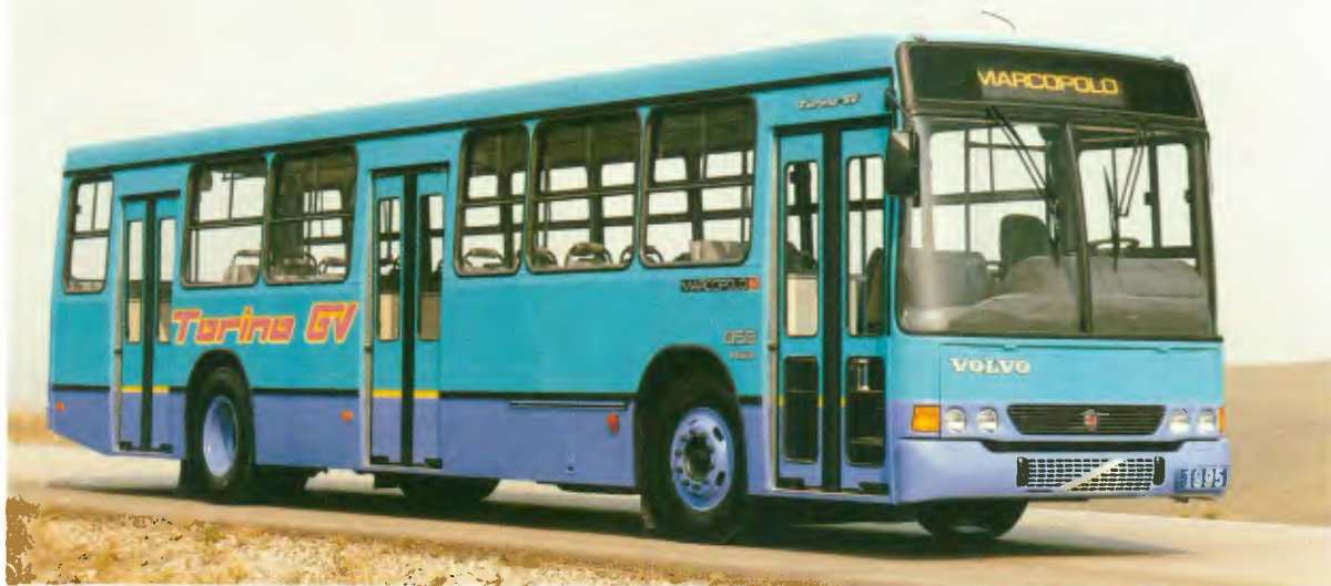
O Torino GV na versão três portas sobre chassi Volvo B58, com 13,20 m de comprimento
