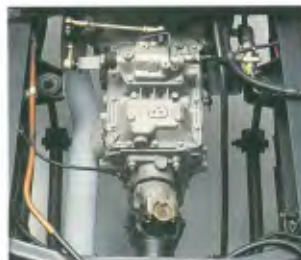
Câmbio de 6 marchas com alta capacidade de sincronização, que requer menor esforço de engate.
