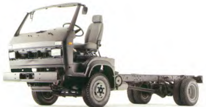
Chassi 8.140: base para microônibus e veículos de aplicações especiais
