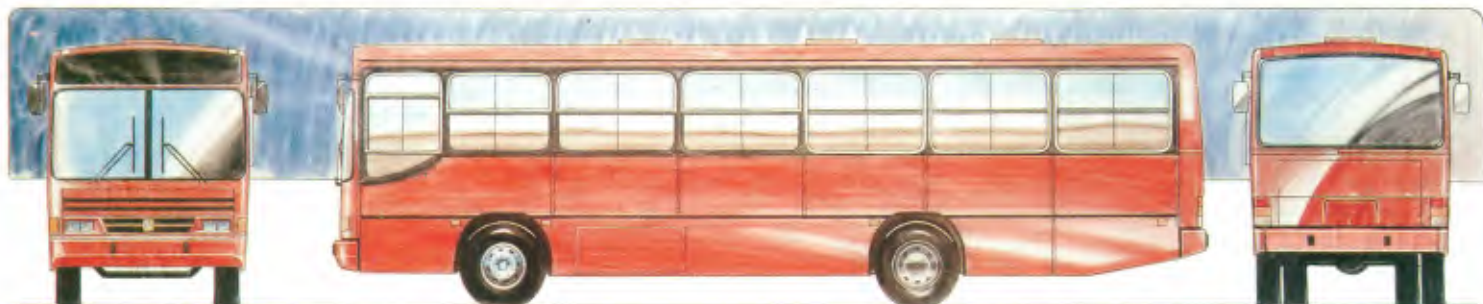
Desenho da carroceria Urbanus-95: alterações na frente, na traseira e nas janelas
