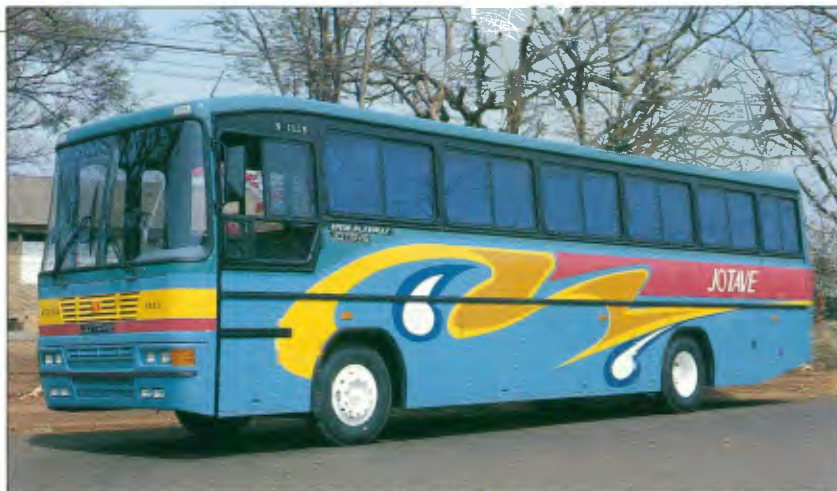
Carroceria Jotave modelo Stilus 3.40 sobre chassi VW 16.180 (Volksbus): 12 m de comprimento e 45 lugares
