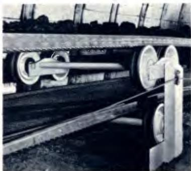
Quando do detalhamento do projeto "Anchor", surgiu a necessidade de se interligar as usinas componentes do complexo. Decidiu-se fazer esta comunicação utilizando *cabl-belt*, ou seja, correias transportadoras apoiadas em cabos de aço.
