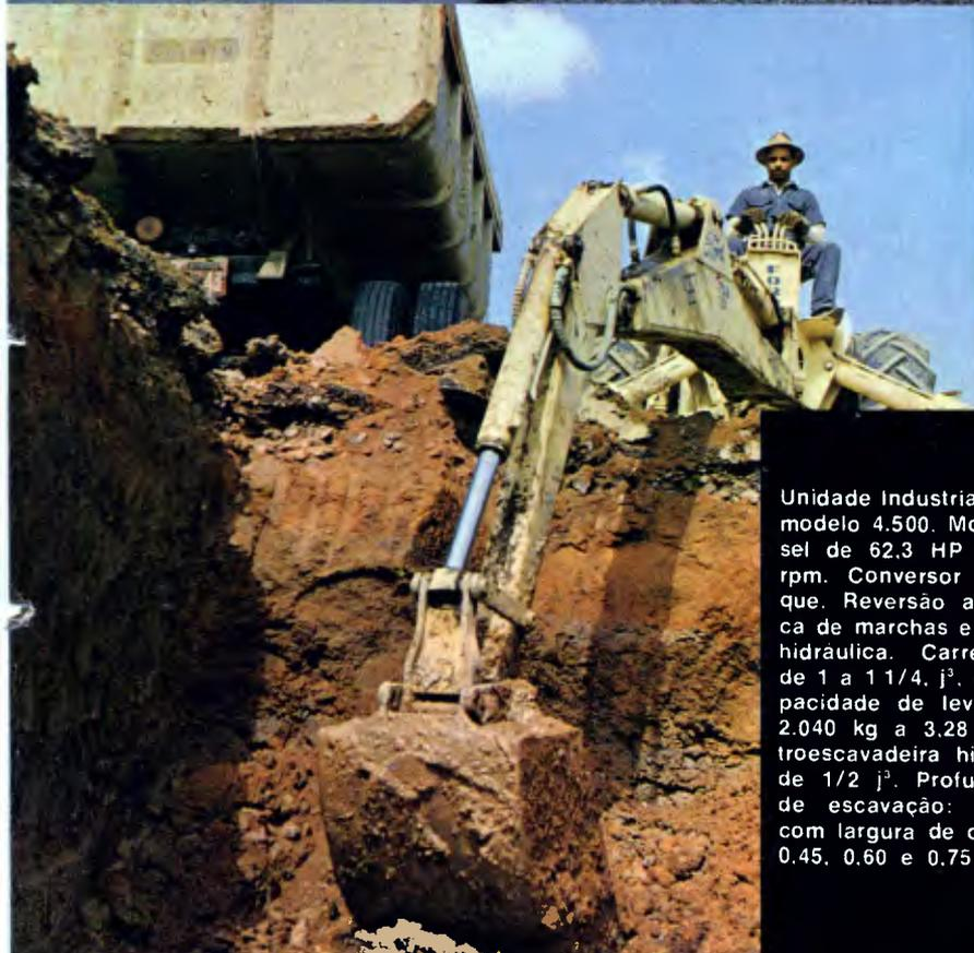
Unidade Industrial FORD, modelo 4.500. Motor diesel de 62,3 HP a 2.200 rpm. Conversor de torque. Reversão automática de marchas e direção hidráulica. Carregadeira de 1 a 1 1/4 j<sup>3</sup>, com capacidade de levantar de 2.040 kg a 3.28 m. Retroescavadeira hidráulica de 1/2 j<sup>3</sup>. Profundidade de escavação: 4,61 m com largura de corte de 0,45, 0,60 e 0,75 m.
