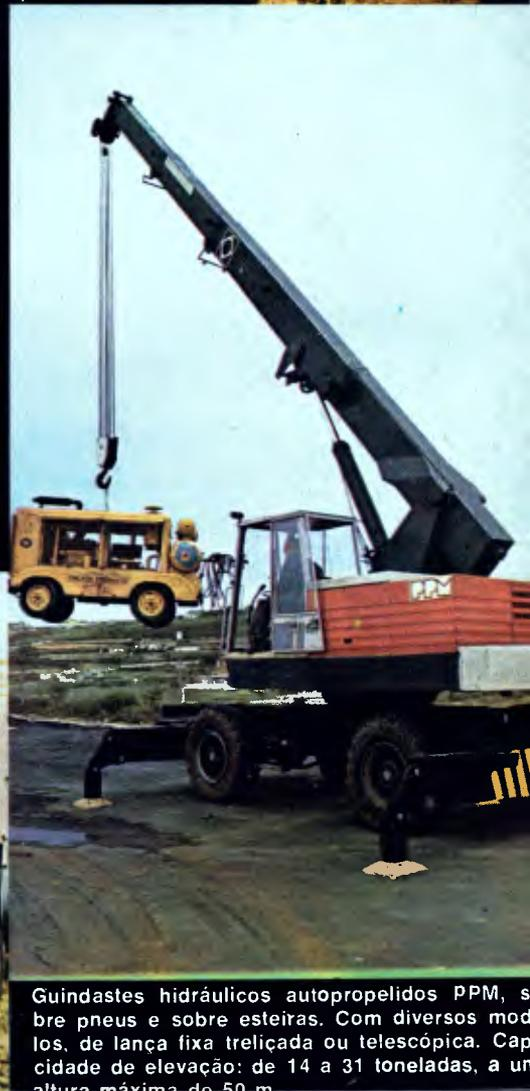
Guindastes hidráulicos autopropelidos PPM, sobre pneus e sobre esteiras. Com diversos modelos, de lança fixa treliçada ou telescópica. Capacidade de elevação: de 14 a 31 toneladas, a uma altura máxima de 50 m.
