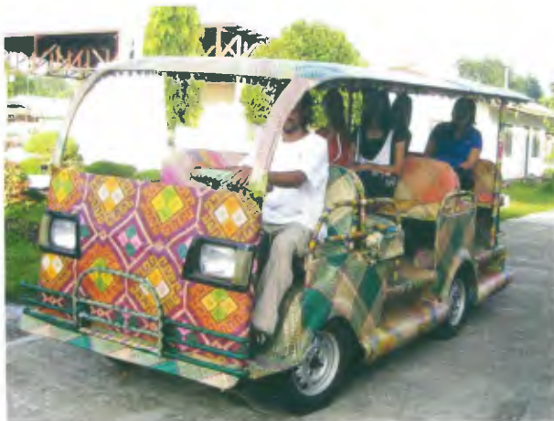
O minibus Toti Eco tem estrutura e acabamento de bambu
