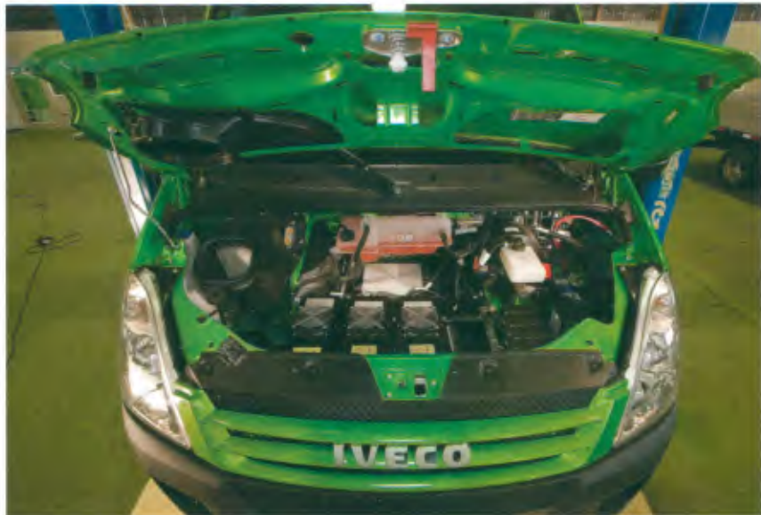
As três baterias do veículo têm vida útil de cerca de mil cargas
