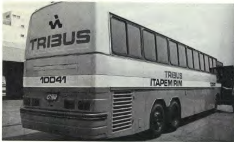
Carroçaria Nielson, a escolhida, tem 13,20 m de comprimento contra 13,01 m da Ciferal. A pintura foi alterada. Sumiu a tradicional faixa sobre o teto de ônibus
