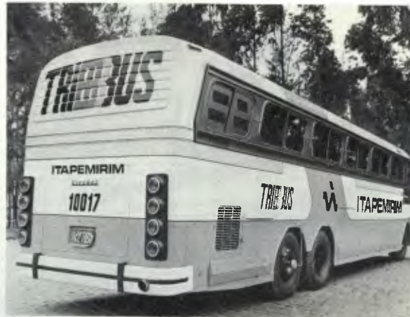
Carroçaria Nielson, a escolhida, tem 13,20 m de comprimento contra 13,01 m da Ciferal. A pintura foi alterada. Sumiu a tradicional faixa sobre o teto de ônibus
