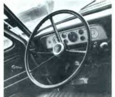
No painel, basta instalar o botão do pré-aquecedor e um vacuômetro.
