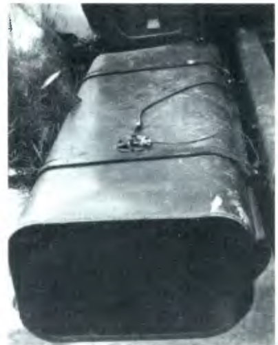
O tanque recebe um tubo que faz retornar o excesso de combustível.
