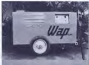
WAP-ELAN - máquina a alta pressão e água quente para pré-lavagem de veículos e limpeza de peças etc.
