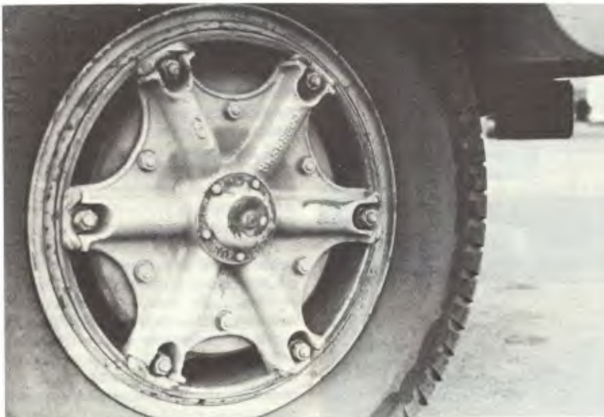
O aro do sem câmara, maior, é melhor que este para refrigerar o freio
