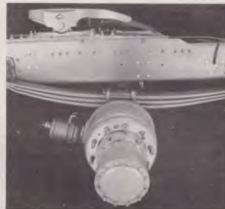
Eixo dianteiro: três molas parabólicas substituíram as dez semi-elípticas
