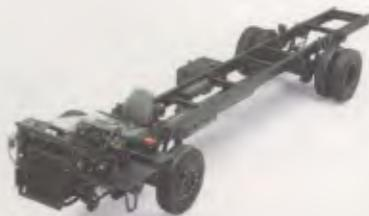
completo, coluna de direção com cobertura, pedaleira e capuz do motor. Possui longarinas retas e sem rebites, o que facilita o encarroçamento. Opção para 2 distâncias entre eixos: 5.170mm e 5.940mm.
