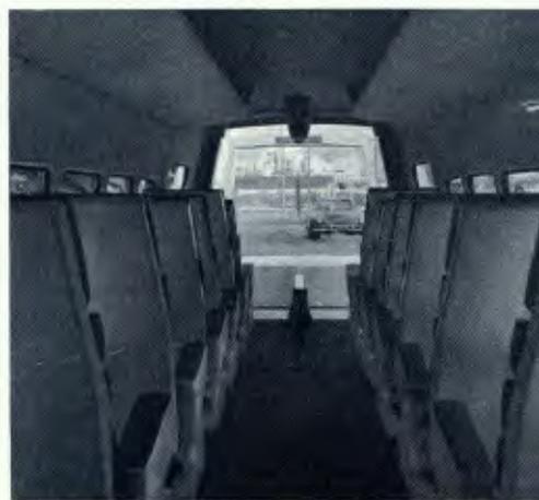
O protótipo mostrado na Brasil Export tem capacidade para vinte passageiros; mede 15,65 m de comprimento, 2,20 m de largura e 2,86 m de altura máxima. Pesa cerca de 3 t em ordem de marcha e 6 t com carga total. Sua velocidade máxima é de 200 km/h. Mas os planos prevêem a construção de modelos maiores, para até 250 passageiros, com velocidade de 500 km/h.
